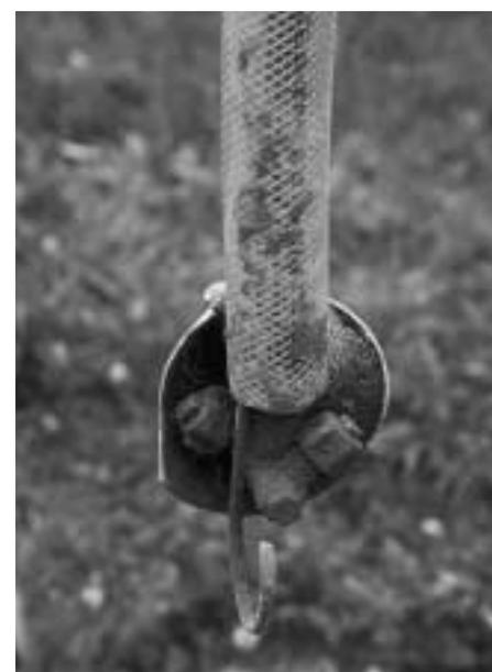
Abb. 6: Die gefederten Düsensträger sind am Spritzgestänge senkrecht und waagrecht verstellbar (Fischer, Prototyp 2).
