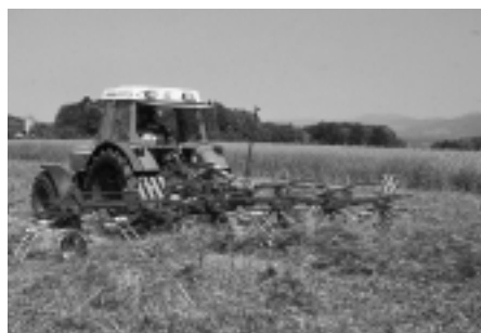
Fig. 14: S'il est impossible de renoncer à la pirouette, cette dernière doit alors être passée avec autant de ménagement que possible (bas régime, vitesse d'avancement pas trop faible).
