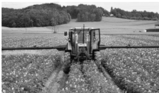
Fig. 1: Dans un peuplement dense, il a été possible d'empêcher le mildiou en pulvérisant 400 l de bouillie par hectare à une pression de 7 bar et une vitesse d'avancement de 5 km/h. A droite: les voies de passages permettent d'intervenir à temps et d'équiper les machines de pneus plus larges.
