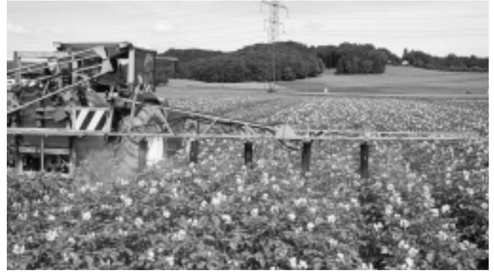
Fig. 6: Le système de pulvérisation sous-foliaire a permis de traiter uniformément les feuilles et les tiges à partir de deux buses placées en bas et en haut (prototype).
