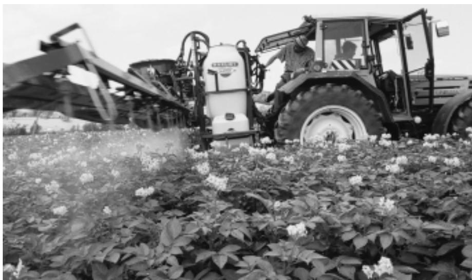
Fig. 5: Les buses à injection d'air produisent des bulles remplies d'air, qui sous l'effet d'accélération dû à la pression (9 bar) pénètrent en profondeur dans la végétation. Gauche/Droite: Buses à jet plat à injection d'air, individuelles/doubles.
