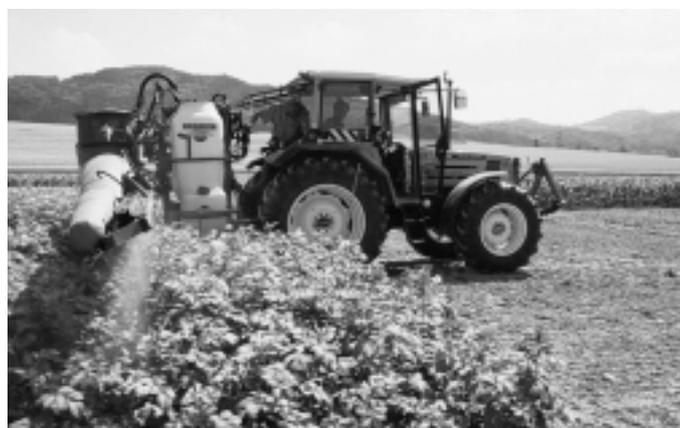
Fig. 2: L'assistance pneumatique fournie par une souffluse axiale améliore la pénétration dans la culture et réduit la dispersion.
