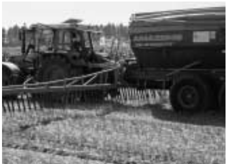
Fig. 22: Les boues d'épuration séchées se traduisent par un important développement de poussière lorsqu'elles sont épandues avec des dispositifs à disques, notamment lorsque la granulométrie des engrais n'est pas favorable (photo de gauche). Les épandeurs universels équipés d'une vis d'épandage peuvent même épandre des engrais pulvérulents sans développer trop de poussière et en atteignant une répartition transversale exacte.
