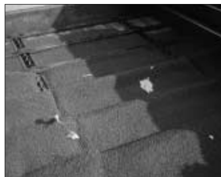
Fig. 6: Le fond mouvant traditionnel ne convient pas pour les engrais en vrac, car il glisse sous la charge. C'est pourquoi pour les boues séchées et la chaux, les épandeurs doivent être équipés d'un tapis roulant en caoutchouc.
