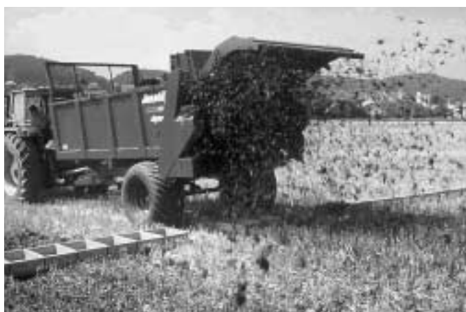
Fig. 1: Le fumier et les engrais à base de déchets doivent être épandus dans la quantité recommandée, le plus exactement et le plus finement possible, en ménageant les sols. Les essais d'épandage en plein champ ont servi à étudier l'adéquation des différents systèmes.
