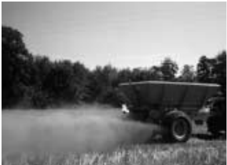
Fig. 22: Les boues d'épuration séchées se traduisent par un important développement de poussière lorsqu'elles sont épandues avec des dispositifs à disques, notamment lorsque la granulométrie des engrais n'est pas favorable (photo de gauche). Les épandeurs universels équipés d'une vis d'épandage peuvent même épandre des engrais pulvérulents sans développer trop de poussière et en atteignant une répartition transversale exacte.
