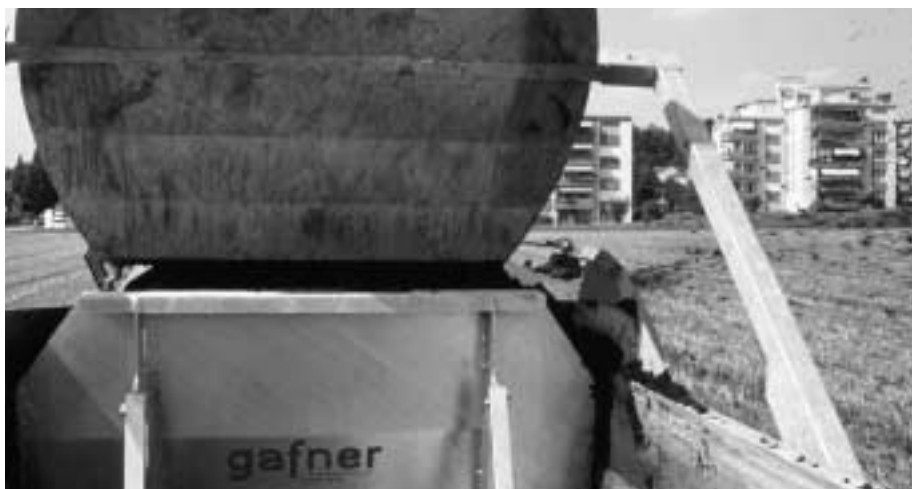
Fig. 19: Grâce à leur paroi coulissante, les épandeurs latéraux permettent d'obtenir une bonne répartition longitudinale. Ils sont bien adaptés aux terrains en pente et conviennent pour les engrais les plus divers. Cependant, la puissance nécessaire pour l'entraînement du dispositif d'épandage est assez élevée.
