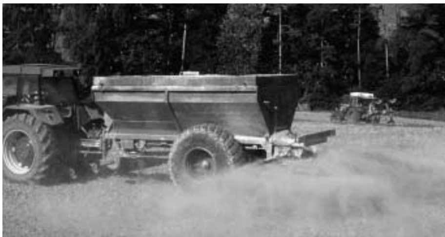
Fig. 20: Pour la répartition et le dosage exacts de la chaux Ricoter, ce sont les épandeurs universaux spéciaux avec tapis roulant et dispositif à deux disques disperseurs qui conviennent le mieux.
