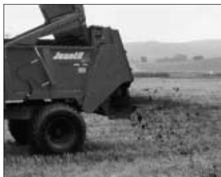
Fig. 3: La porte-guillotine relevée pendant le procédé d'épandage répartit la charge de manière homogène devant le dispositif d'épandage. De cette manière, le déchargement et la répartition longitudinale s'effectuent plus régulièrement.
