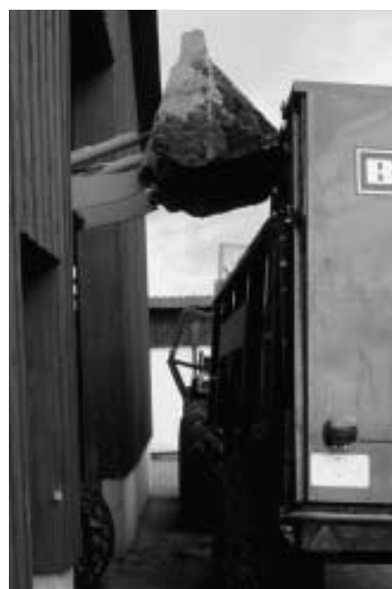
Fig. 14: Pour les épandeurs de construction élevée, les chargeurs frontaux ou automoteurs utilisés doivent avoir une hauteur de levage suffisante pour permettre un chargement rationnel.
