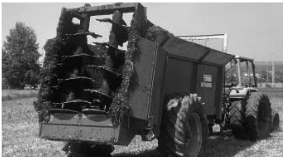
Fig. 18: Les épandeurs monocoque surbaissés sont spécialement conçus pour l'épandage du fumier de stabulation libre grâce à leur dispositif robuste et à leurs deux vis verticales. Leur poids à vide est toutefois considérable.
