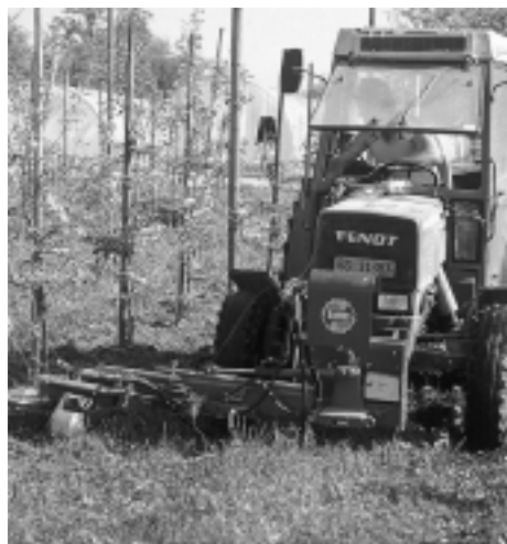
Abb. 2: Ein guter Arbeitseffekt erfordert eine exakte Einstellung der Tastarmsteuerung (Humus). Mitte: Die 15cm-Messer mit Messerkrümmung nach innen sind den 10cm-Messern vorzuziehen (rechts).
