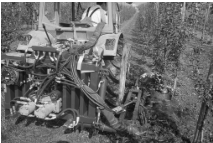
Abb. 1: Für die Unkrautregulierung und Bodenpflege reichen mehrheitlich vier bis fünf Hackdurchgänge aus. Links: Ladurner, mit separatem Ölkreislauf mit Kühlrippentank und Ventilator; rechts: Arbeitseffekt in Baumstreifen mit Humus.
