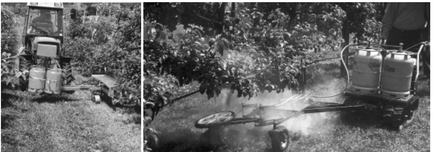
Abb. 6: Die rein thermische Unkrautregulierung ist mit relativ hohem Propangasverbrauch verbunden. Links/rechts: Abflamngerät am Traktor bzw. Raupenfahrzeug (oft Entflammgefahr bei Grasbüschel).
