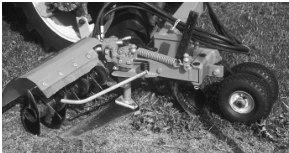
Abb. 3: Der Boden wird mit Flachschar unterschritten sowie mit dem Messerrotor zerkleinert und eingemulcht (Müller).
