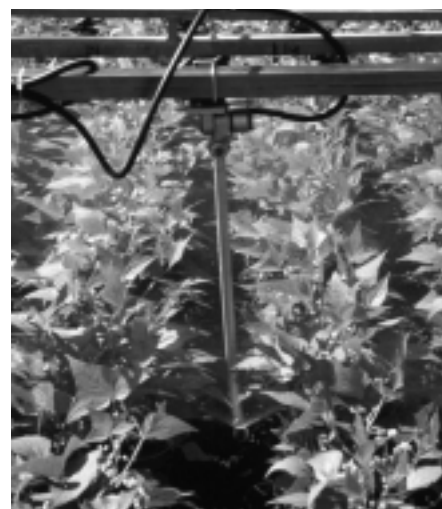
Fig. 1: Les meilleurs résultats en terme de dépôt des fongicides ont été obtenus avec un dispositif de pulvérisation sous-foliaire, également dans les cultures denses de haricots nains. A droite: Un élément de pulvérisation de Benest/GB.
