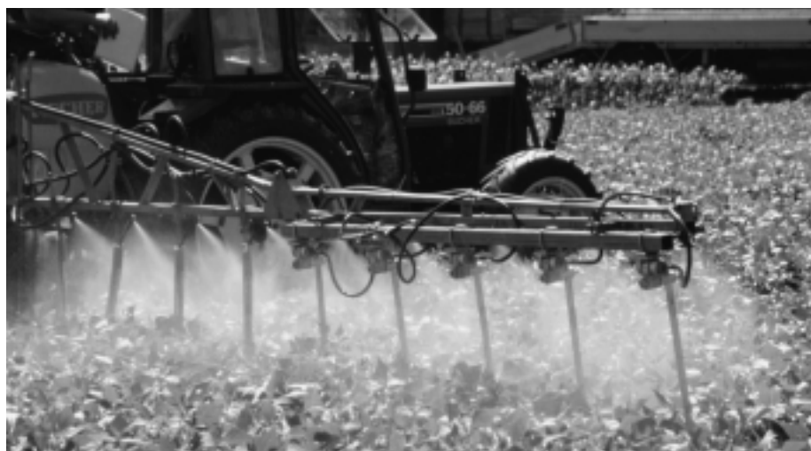
Fig. 1: Les meilleurs résultats en terme de dépôt des fongicides ont été obtenus avec un dispositif de pulvérisation sous-foliaire, également dans les cultures denses de haricots nains. A droite: Un élément de pulvérisation de Benest/GB.
