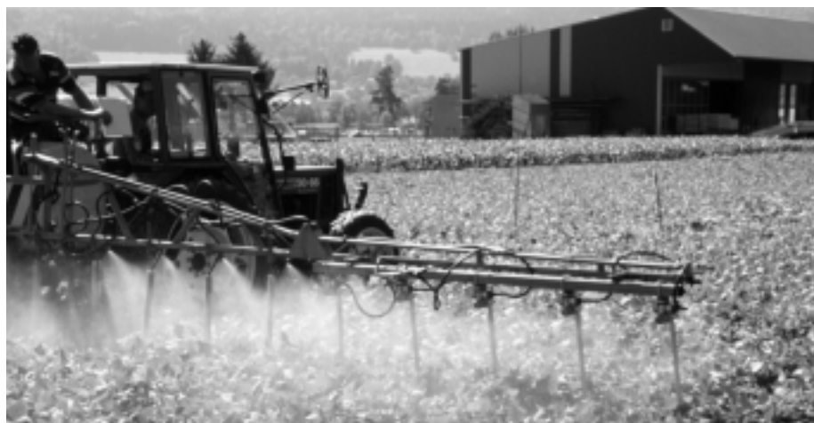
Fig. 6: Dans le cas de la pulvérisation sous-foliaire, les haricots sont vaporisés en biais par le haut et également par le bas. De gauche à droite, cinq éléments de Fischer et de Benest.
