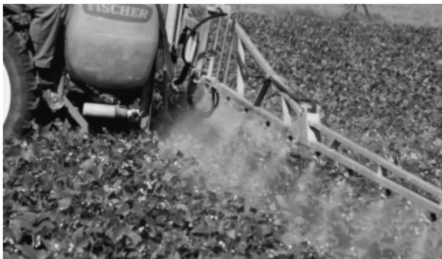
Fig. 5: Amélioration de la pulvérisation standard avec réglage des buses en biais: avant/arrière, Teejet XR/TT.
