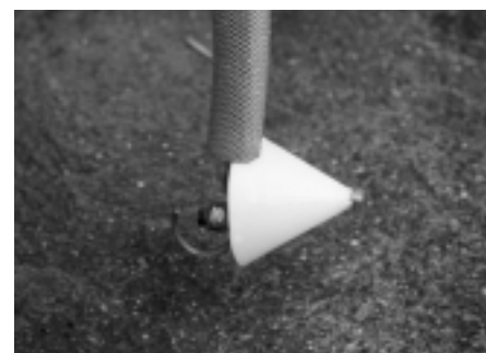
Fig. 6.1+6.2: Avec l'élément de pulvérisation sous-foliaire de Fischer, les plantes sont traitées par le bas avec buses réglables à jet plat. La protection de la buse en forme de trémie s'est avérée satisfaisante, mais doit encore être améliorée.
