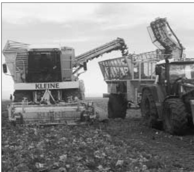
Abb. 4: Sechsheihiger selbstfahrender Kopfrodebunker der kleinen Baugröße (KRB SF 6, klein). Bei geringen Feldlänge können die Rüben bis ans Feldende transportiert werden. Bei grossen Feldlängen ist der Einsatz als Köpfordelader mit Zwischenbunker vorgesehen.
