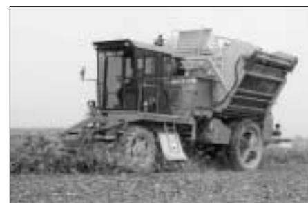
Abb. 2b: Dreireihiger Köpfrödebunker selbstfahrend (KRB SF 3). Mittels Schmal- und Zwillingsbereifungen auf der linken Maschinenseite ist das Gassenroden möglichst (Barigelli).
