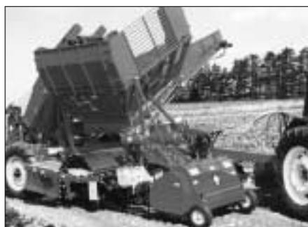
Abb. 2a: Dreireihiger gezogener Köpfrödebunker (KRB 3) mit Schlegelköpfer. Auch die zweireihige Ausführung basiert auf dem gleichen Grundaufbau (TIM).
