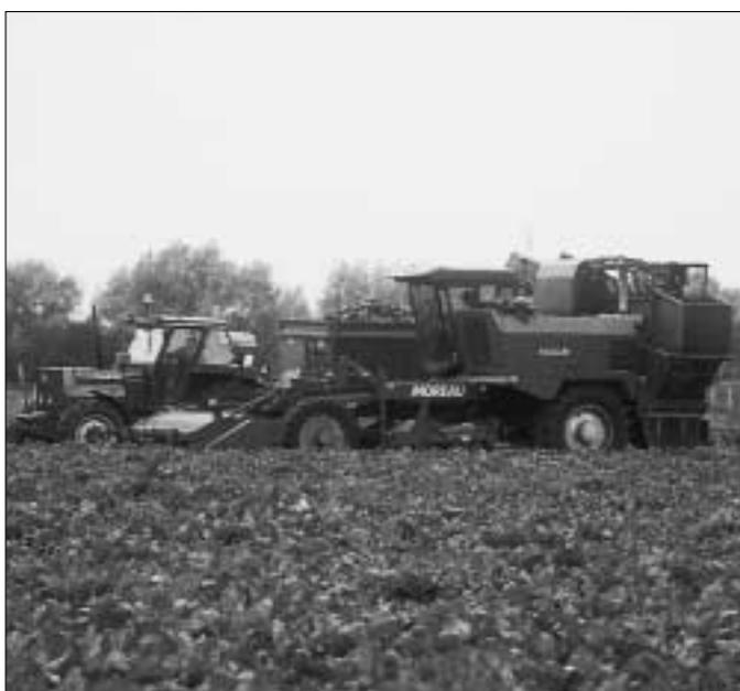
Abb. 5: Selbstfahrende Köpfordelader (KRL) mit bis zu neun Reihen Arbeitsbreite werden bevorzugt in Frankreich eingesetzt, wo die Rübenzwischenlagerung nicht in Feldrandmieten, sondern auf entfernteren befestigten Lagerplätzen erfolgt.
