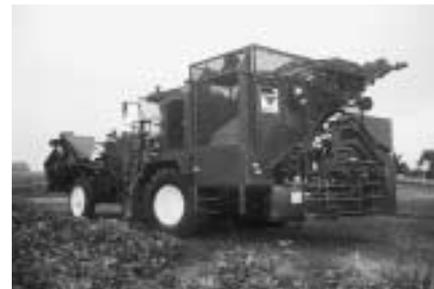
Abb. 1: Die höchsten Arbeitsbreiten werden zur Zeit mit einem neunreihigen Köpfrodelader (KRL SF 9, Moreau) erreicht (a). Für den Strassentransport lassen sich sowohl der zweiteilige Schlegeköpfer als auch die Siebsterreinigung seitlich hochklappen (b).
