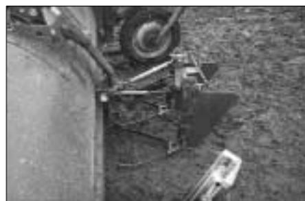
Abb. 14: Für die Ansteuerung der Lenkautomatik wird bei selbstfahrenden Köpfrödebunkern und Köpfrödeladern meistens von den Signalen eines mechanischen Rübenblatttasters vor der Entblätterung ausgegangen.
