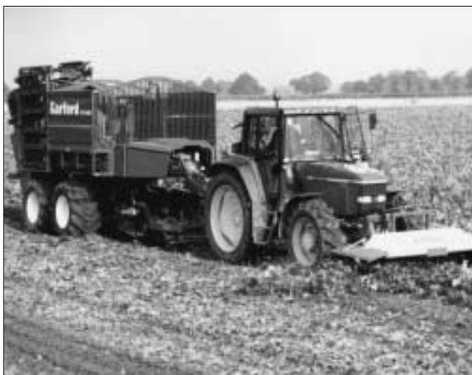
Abb. 3: Das traktorbetriebenen Kopfrodebunkersystem von Garford GB, ist für ein Spursystem (Spurreihen mit grösserem Reihenabstand) für drei, vier oder sechs Reihen konzipiert. Nur der Blattschläger ist am Traktor frontangebaut. Beide Achsen des Rodebunkers sind hydraulisch angetrieben.
