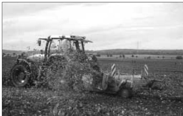
Abb. 6: Köpfroder (KR) als kombinierte Maschine haben den Vorteil, dass im Gegensatz zu getrennten Aggregaten für den Front- und Heckanbau (K,R) die Rübenreihen nicht befahren werden müssen und somit ein «Gareroden» möglich wird.
