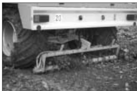
Abb. 20: Mit einer Spiralwalze zum Einebnen der Bodenoberfläche kann die Wasserinfiltration verbessert werden.
