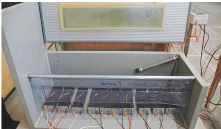
Abb. 3: Geöffnetes Isonest-ATX (Heizplatte 200 W). Der Temperaturfühler befindet sich an der Rückwand.
