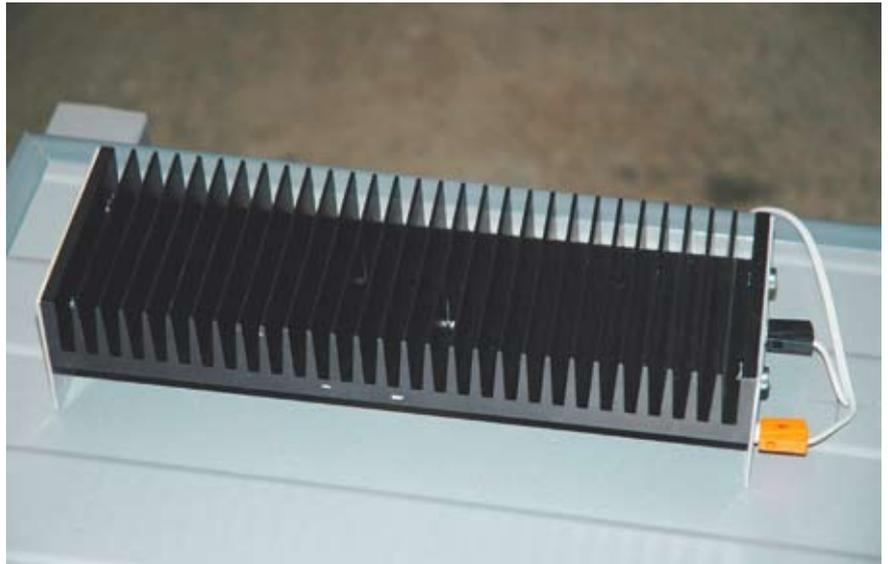
Abb.5 : Künstliches «Ferkel» bestehend aus einem beheizbaren (0–30 W) Aluminiumkörper.
