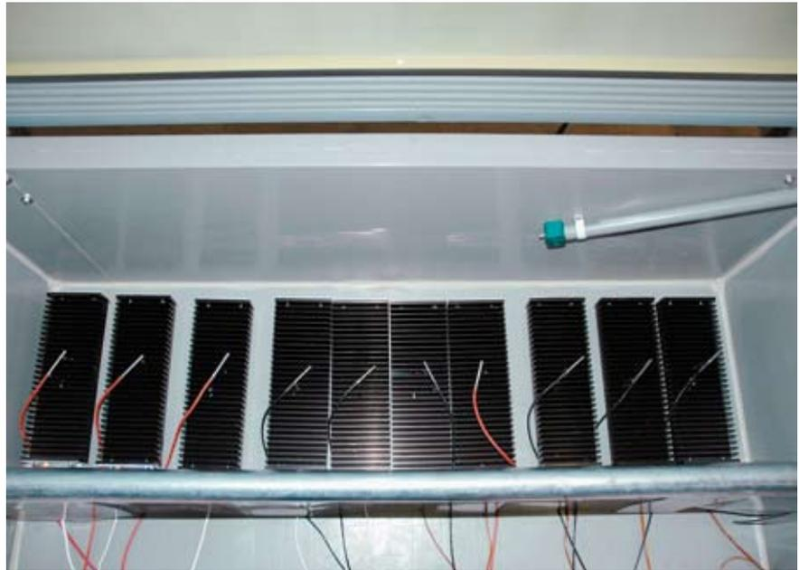
Abb. 6: Simulationsversuch mit künstlichen «Ferkeln». Die zehn Temperaturfühler befinden sich  $2\text{ cm}$  über den «Ferkeln».
