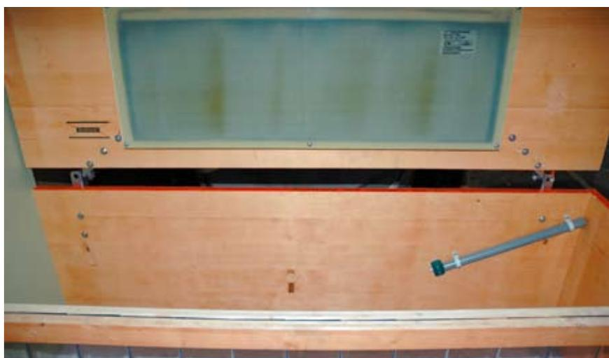
Abb. 4: Geöffnetes konventionelles Nest (Heizplatte 290 W). Die Umwandung besteht aus Betonschalttafeln.
