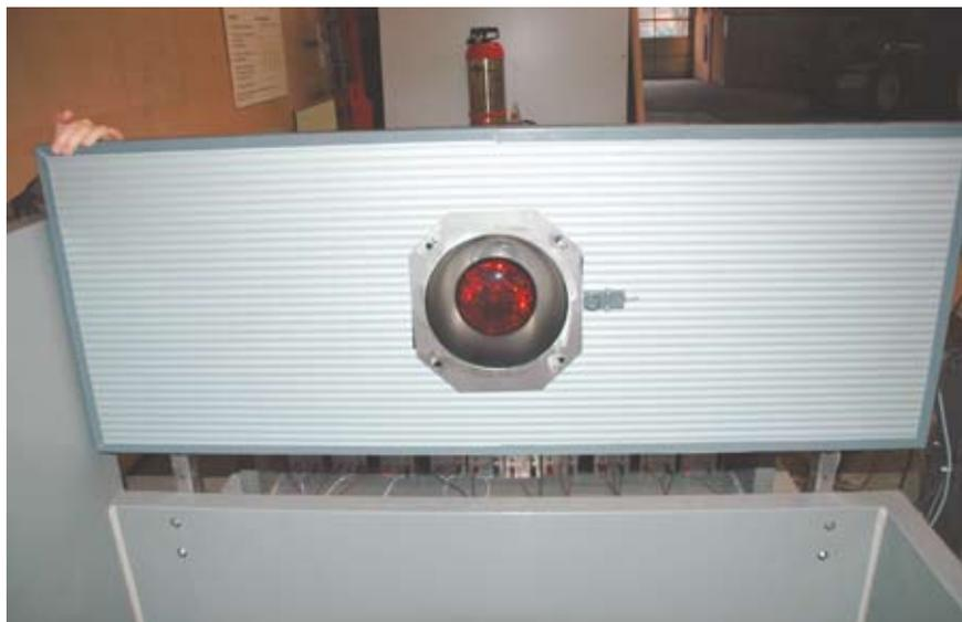
Abb. 2: Geöffnetes Isonest-IR. Rechts neben der IR-Lampe (150 W) ist der IR-Sensor ersichtlich.
