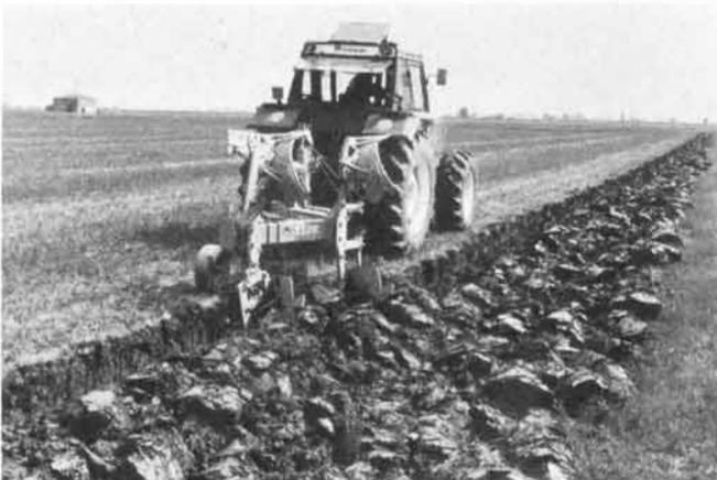
Fig. 14: Les charrues «Onland» permettent d'éviter notamment la formation de semelles de labour et le compactage du sous-sol. Il est souhaitable qu'à l'avenir on accorde plus d'importance à ce point. (photo Nardi)
