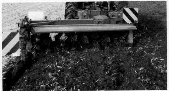
Fig. 2: Charrue rotative (Kuhn): Les résidus de récolte sont mélangés régulièrement avec la terre. On obtient également un bon émiettement dans les sols difficiles à travailler.
