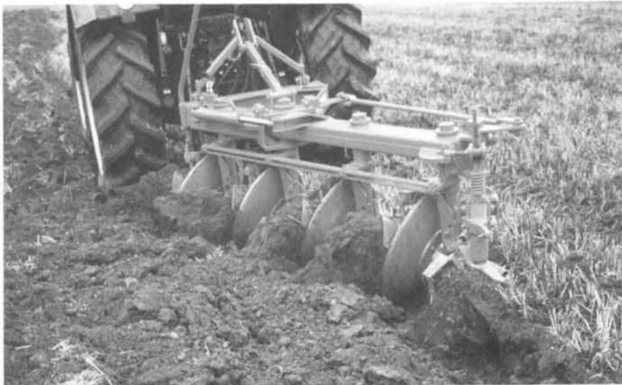
Fig. 5: Charrue pivotante à disques (Galucho): le processus de retournement s'effectue de la même façon que pour la «Swing Plow». Il n'est pas possible de régler l'inclinaison et la largeur du premier sillon.
