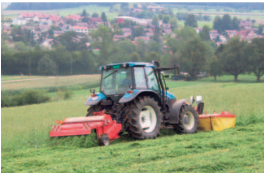
Fig. 5: Le conditionnement de l'herbe lors de la coupe, l'humidité plus importante du fourrage récolté et les machines de récolte plus performantes permettent de tirer un meilleur parti des courtes périodes de beau temps.
