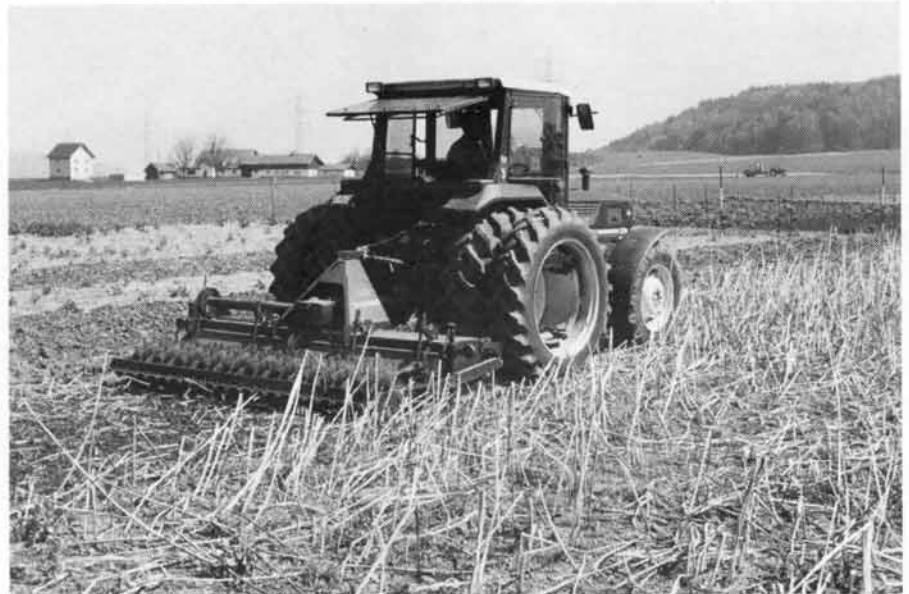
Fig. 3: Travailler le sol sur toute sa surface pour effectuer un semis sous litière (ici avec une herse rotative à axe horizontal dans des tournesols) représente une solution avantageuse, ne nécessitant pas de machines spéciales.
