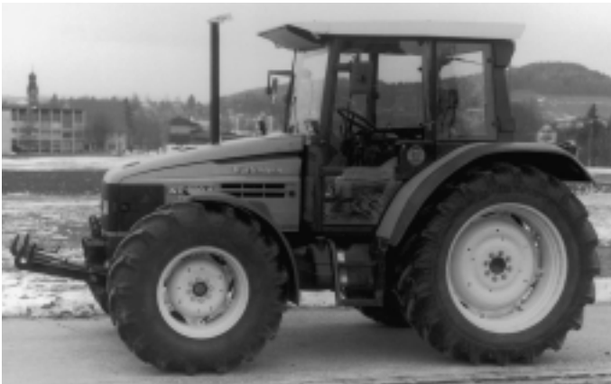
Abb. 3: Traktor HÜRLIMANN XT 910.4, 4-Zylinder-Turbomotor mit 76 kW (103 PS), 3-Stufen-Lastschaltgetriebe (Listenpreis Fr. 86 500.–), Fronthydraulik und Frontzapfwelle (zuzüglich Fr. 7 800.–).
