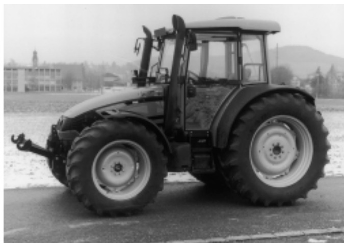
Abb. 8: Traktor DEUTZ-FAHR Agroplus 95, 4-Zylinder-Turbomotor mit 70 kW (95 PS), 3-Stufen-Lastschaltgetriebe, Front-hydraulik und Frontzapfwelle (Listenpreis Fr. 90 300.-).
