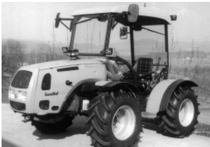
Abb. 9: Wendetraktor LANDINI Discoveri 85, 4-Zylinder-Turbomotor mit 59 kW (80 PS), synchronisiertes Wendegetriebe, (Listenpreis Fr. 55 800.-).
