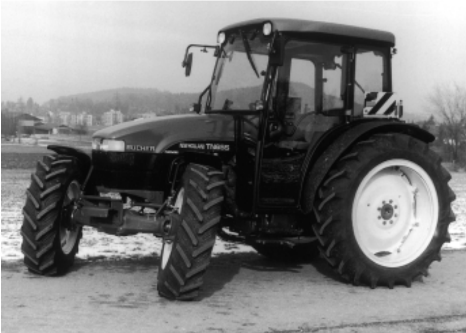
Abb. 2: Die Traktorvorderachse SuperSteer ermöglicht eine Vergrösserung des Lenkwinkels von 55 auf 76°. Der Wendekreis verkleinert sich von 7,9 auf 6,8 m.
