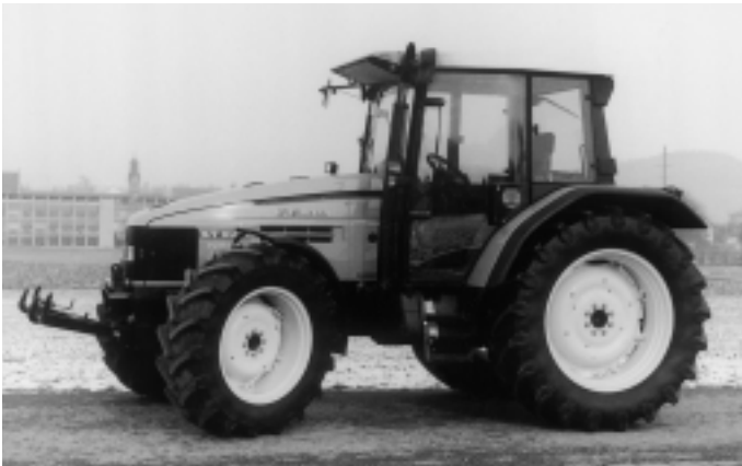
Abb. 4: Traktor HÜRLIMANN XT 910.6, 6-Zylinder-Saugmotor mit 77 kW (105 PS), 3-Stufen-Lastschaltgetriebe (Listenpreis Fr. 93 500.–), Fronthydraulik und Frontzapfwelle (zuzüglich Fr. 7 800.–).
