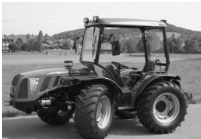
Abb. 14: Zweiwegtraktor BCS Vithar 900 MT, 4-Zylinder-Turbomotor, mit 61 kW (83 PS), synchronisiertes Wendegetriebe, Gewicht 2050 kg, (Listenpreis Fr. 66 497.-), Traktortest-Nr. 1842/02.
