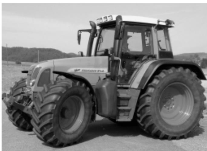
Abb. 5: Traktor FENDT Favorit 714 Vario, 6-Zylinder-Turbomotor mit 4-Ventiltechnik und Ladeluftkühlung, 103 kW (140 PS), stufenloses Fahrgetriebe mit zwei Fahrbereichen, Fronthydraulik und Frontzapfwelle, Vorderachsfederung, Kabinenfederung, Gewicht 6500 kg, (Listenpreis Fr. 170 388.-), Traktortest-Nr. 1829/01.
