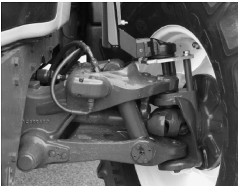
Abb. 1: Die Vorderachsfederung verhindert das Aufschaukeln des Traktors. Nickschwingungen am Fahrersitz werden stark vermindert, der Fahrkomfort verbessert. Die Fahrsicherheit im Geschwindigkeitsbereich schneller als 30 km/h wird wesentlich erhöht.
