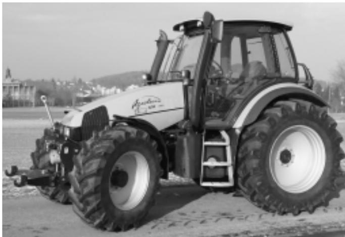
Abb. 9: Traktor DEUTZ-FAHR Agrottron 120 MK3, 6-Zylinder-Turbomotor, 92 kW (125 PS), 4-Stufen-Lastschaltgetriebe, Fronthydraulik und Frontzapfwelle, Vorderachsfederung, Gewicht 6280 kg, (Listenpreis Fr. 124 700.-), Traktortest-Nr. 1836/02.
