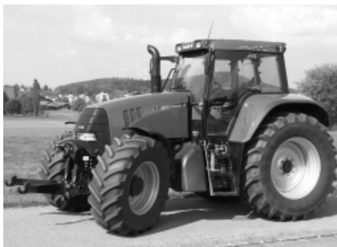
Abb. 7: Traktor CASE IH CVX 150, 6-Zylinder-Turbomotor, 107 kW (145 PS), stufenloses Fahrgetriebe mit drei Fahrbereichen, Fronthydraulik, Vorderachsfederung, Kabinenfederung, Gewicht 7150 kg, (Listenpreis Fr. 162 600.–), Traktortest-Nr. 1844/02.
