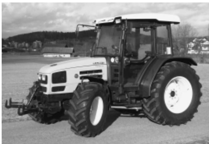
Abb. 12: Traktor HÜRLIMANN XA 658, 4-Zylinder-Turbomotor, mit 61 kW (83 PS), 3-Stufen-Lastschaltgetriebe, Fronthydraulik und Frontzapfwelle, Gewicht 3300 kg, (Listenpreis Fr. 79 400.-), Traktortest-Nr. 1837/02.
