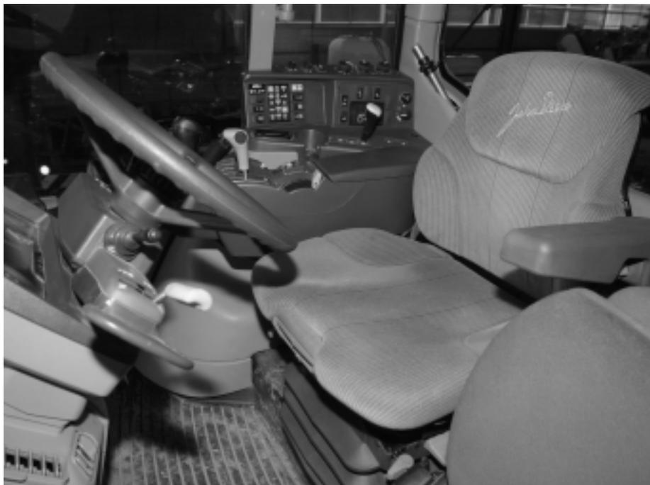
Abb. 2: Ein bequemer Fahrersitz mit einer guten Federung und einstellbaren Längs- und Seiten-Horizontalfederung schont den Rücken auch vor Schwingungen und schmerzhaften Stössen in Längs- und Querrichtung.
