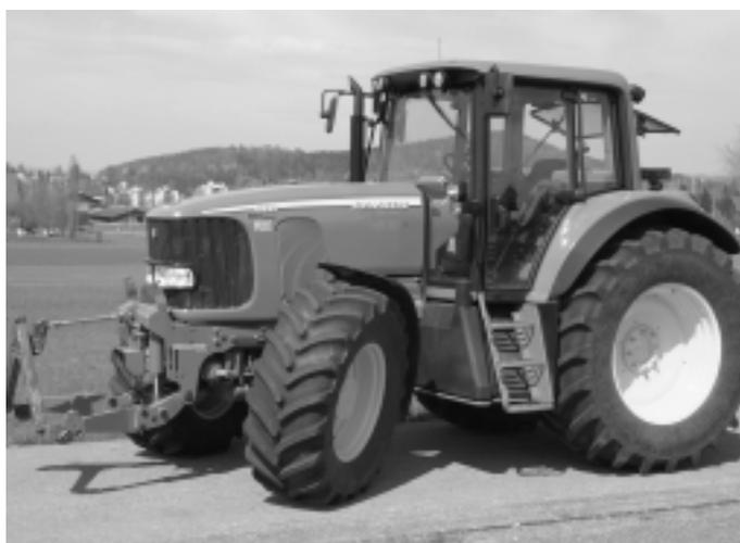
Abb. 6: Traktor JOHN DEERE 6920 AutoPowr, 6-Zylinder-Turbomotor mit Ladeluftkühlung, 110 kW (150 PS), stufenloses Fahrgetriebe, Fronthydraulik und Frontzapfwelle, Vorderachsfederung, Kabinenfederung, Gewicht 6840 kg, (Listenpreis Fr. 171 850.-), Traktortest-Nr. 1843/02.
