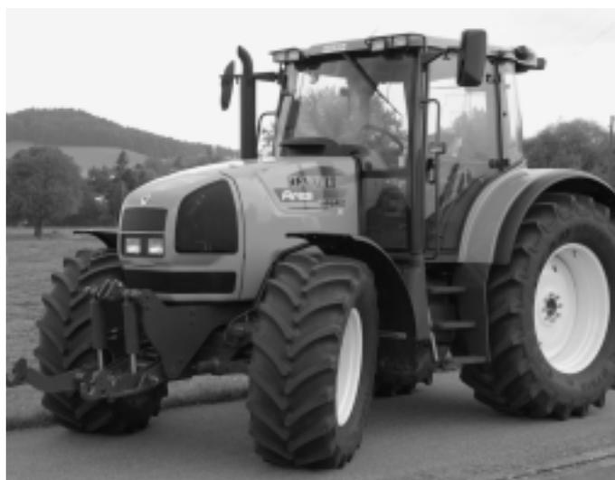
Abb. 8: Traktor RENAULT Ares 696 RZ, 6-Zylinder-Turbomotor, 104 kW (140 PS), 4-Stufen-Lastschaltgetriebe, Fronthydraulik, Vorderachsfederung, Kabinenfederung, Gewicht 6400 kg, (Listenpreis Fr. 126 423.–), Traktortest-Nr. 1834/02.
