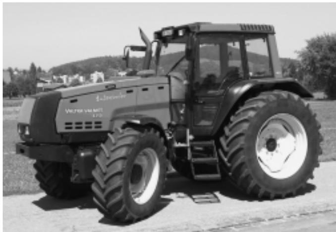
Abb. 10: Traktor VALTRA VALMET 8350-4 HiTech, 6-Zylinder-Turbomotor, 99 kW (135 PS), 3-Stufen-Lastschaltgetriebe, Vorderachsfederung, Gewicht 5720 kg, (Listenpreis Fr. 120 200.-), Traktortest-Nr. 1830/01.
