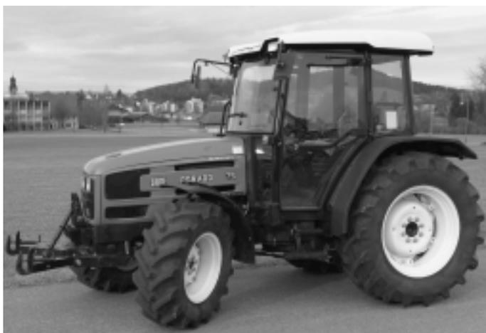
Abb. 11: Traktor SAME Dorado 75, 4-Zylinder-Saugmotor mit 53 kW (72 PS), 3-Stufen-Lastschaltgetriebe, Fronthydraulik und Frontzapfwelle, Gewicht 3110 kg, (Listenpreis Fr. 73 100.-), Traktortest-Nr. 1835/02.
