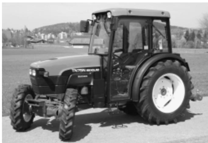
Abb. 13: Schmalspurtraktor NEW HOLLAND TN75 N, 3-Zylinder-Turbomotor mit 53 kW (72 PS), 2-Stufen-Lastschaltgetriebe, Traktovorderachse SuperSteer, Gewicht 2530 kg, (Listenpreis Fr. 66 280.-), Traktortest-Nr. 1838/02.
