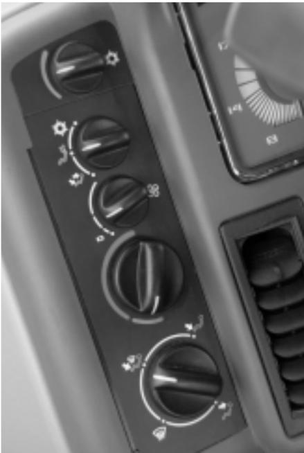
Abb. 3: Die Klimaanlage trägt an heißen Sommertagen wesentlich zum Wohlbefinden des Fahrpersonals bei. Der Energieverbrauch der zu geschalteten Klimaanlage erhöht jedoch den Treibstoffverbrauch des Traktors um bis zu 1,5 Liter je Stunde.
