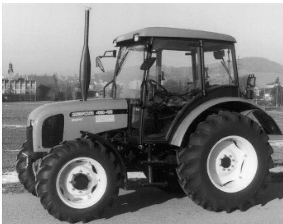
Fig. 11: Tracteur ZETOR 4341 Super, moteur d'aspiration quatre cylindres de 44 kW (60 CV), boîte de vitesses à 5 rapports partiellement synchronisée (prix catalogue: Fr. 55 806.-).
