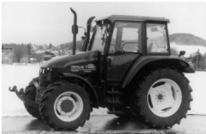
Fig. 7: Tracteur NEW HOLLAND TS 90, moteur turbo quatre cylindres de 70 kW (95 CV), boîte de vitesses à passage sous charge à 4 rapports, système hydraulique et prise de force frontaux (prix catalogue: Fr. 97 560.-).
