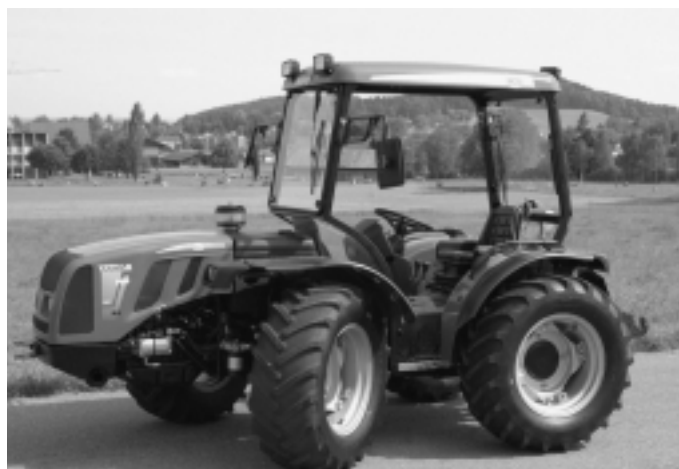
Fig. 14: Tracteur réversible BCS Vithar 900 MT, moteur turbo quatre cylindres, 61 kW (83 CV), transmission réversible synchronisée, poids 2050 kg (prix catalogue: Fr. 66 497.-), rapport de test n° 1842/02.
