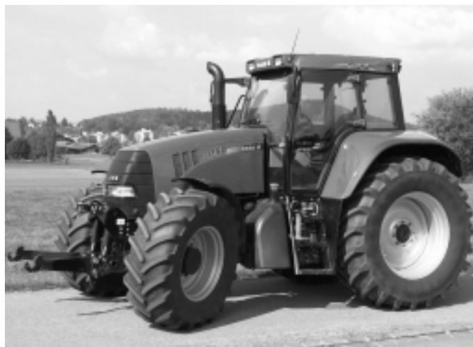
Fig. 7: Tracteur CASE IH CVX 150, moteur turbo six cylindres, 107 kW (145 CV), transmission en continu à trois plages de vitesse, hydraulique frontale, suspension avant, suspension de la cabine, poids 7150 kg (prix catalogue: Fr. 162 600.-), rapport de test n° 1844/02.
