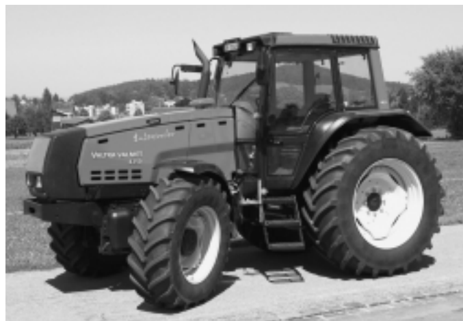
Fig. 10: Tracteur VALTRA VALMET 8350-4 HiTech, moteur turbo six cylindres, 99 kW (135 CV), transmission à 3 paliers de charge, suspension avant, poids 5720 kg (prix catalogue: Fr. 120 200.-), rapport de test n° 1830/01.
