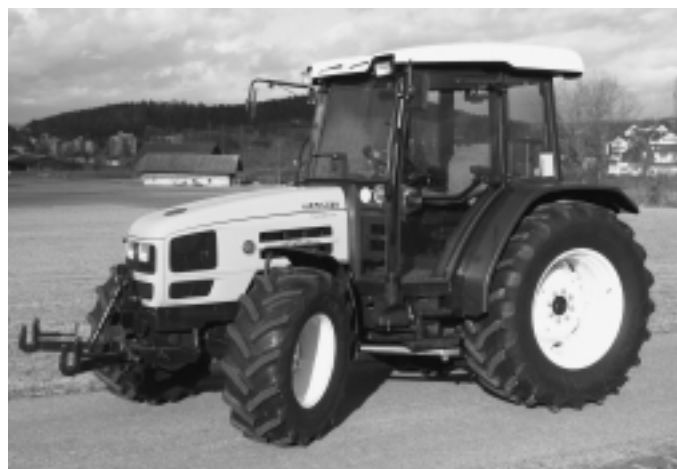
Fig. 12: Tracteur HÜRLIMANN XA 658, moteur turbo quatre cylindres, 61 kW (83 CV), transmission à 3 paliers de charge, hydraulique et prise de force frontales, poids 3300 kg (prix catalogue: Fr. 79 400.-), rapport de test n° 1837/02.
