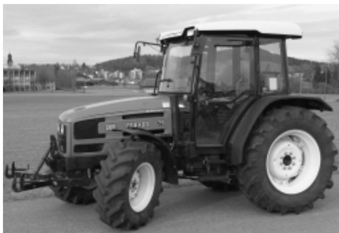
Fig. 11: Tracteur SAME Dorado 75, moteur à aspiration quatre cylindres, 53 kW (72 CV), transmission à 3 paliers de charge, hydraulique et prise de force frontales, poids 3110 kg (prix catalogue: Fr. 73 100.-), rapport de test n° 1835/02.
