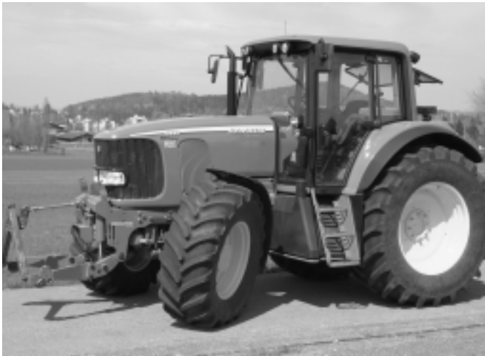
Fig. 6: Tracteur JOHN DEERE 6920 AutoPowr, moteur turbo six cylindres, refroidissement d'air de suralimentation, 110 kW (150 CV), transmission en continu, hydraulique et prise de force frontales, suspension avant, suspension de la cabine, poids 6840 kg (prix catalogue: Fr. 171 850.-), rapport de test n° 1843/02.
