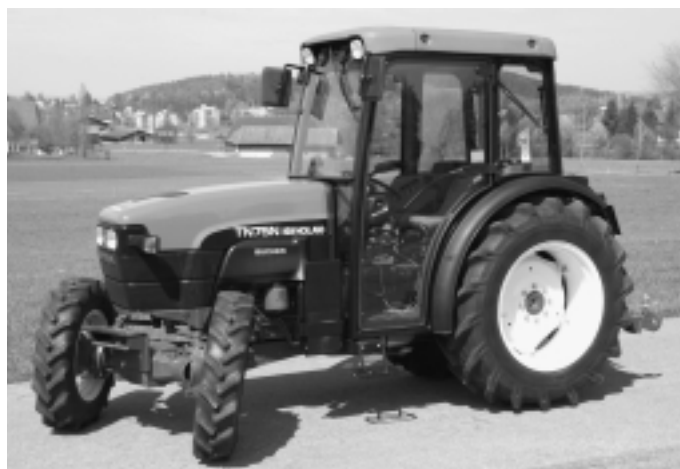
Fig. 13: Tracteur étroit NEW HOLLAND TN75 N, moteur turbo trois cylindres, 53 kW (72 CV), transmission à 2 paliers de charge, essieu avant SuperSteer, poids 2530 kg (prix catalogue: Fr. 66 280.-), rapport de test n° 1838/02.
