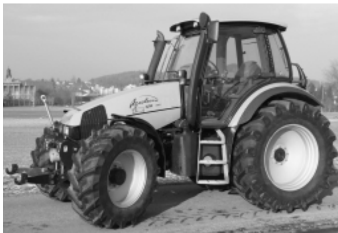
Fig. 9: Tracteur DEUTZ-FAHR Agroton 120 MK3, moteur turbo six cylindres, 92 kW (125 CV), transmission à 4 paliers de charge, hydraulique et prise de force frontales, suspension avant, poids 6280 kg (prix catalogue: Fr. 124 700.-), rapport de test n° 1836/02.
