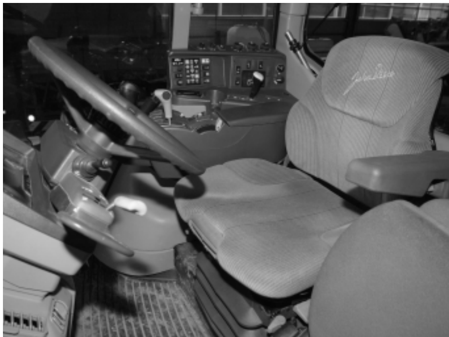
Fig. 2: Un siège conducteur confortable avec une bonne suspension générale et une suspension horizontale réglable en longueur et sur les côtés protège également le dos des oscillations et des à-coups douloureux dans le sens longitudinal et transversal.
