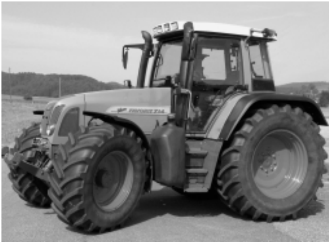
Fig. 5: Tracteur FENDT Favorit 714 Vario, moteur turbo six cylindres, quatre soupapes et refroidissement d'air de suralimentation, 103 kW (140 CV), transmission en continu à deux plages de vitesse, hydraulique et prise de force frontales, suspension avant, suspension de la cabine, poids 6500 kg (prix catalogue: Fr. 170 388.-), rapport de test n° 1829/01.
