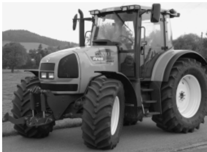
Fig. 8: Tracteur RENAULT Ares 696 RZ, moteur turbo six cylindres, 104 kW (140 CV), transmission à 4 paliers de charge, hydraulique frontale, suspension avant, suspension de la cabine, poids 6400 kg (prix catalogue: Fr. 126 423.-), rapport de test n° 1834/02.
