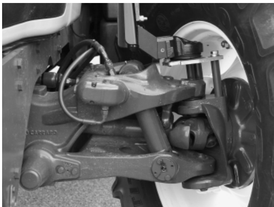
Fig. 1: La suspension avant empêche le tracteur de tanguer. Les rotations planes au niveau du siège du conducteur sont considérablement réduites et la conduite plus confortable. La sécurité de conduite dans la plage de vitesse supérieure à 30 km/h s'en trouve considérablement accrue.
