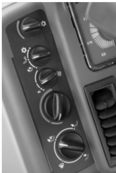
Fig. 3: La climatisation contribue considérablement au bien-être du conducteur pendant les chaudes journées d'été. La consommation d'énergie du système de climatisation, lorsqu'il est enclenché, augmente toutefois la consommation de carburant du tracteur. La consommation supplémentaire peut aller jusqu'à 1,5 litres par heure.
