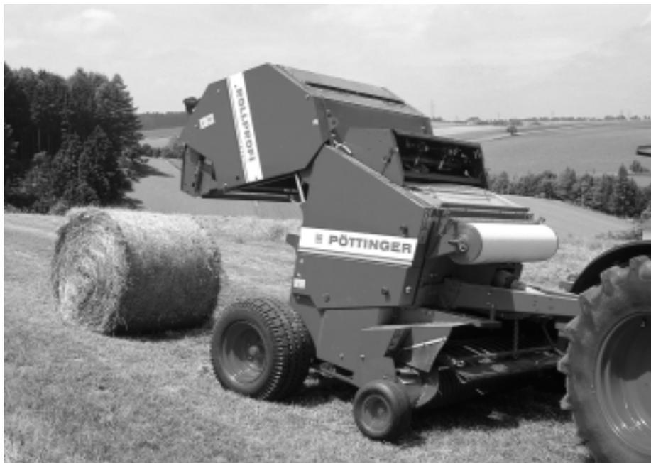
Abb. 2: Rundballenpresse im Einsatz. Anwelken und angemessene Fahrgeschwindigkeit beim Pressen verhelfen zu gleichmässig geformten Silageballen (Werkfoto: Pöttinger).
