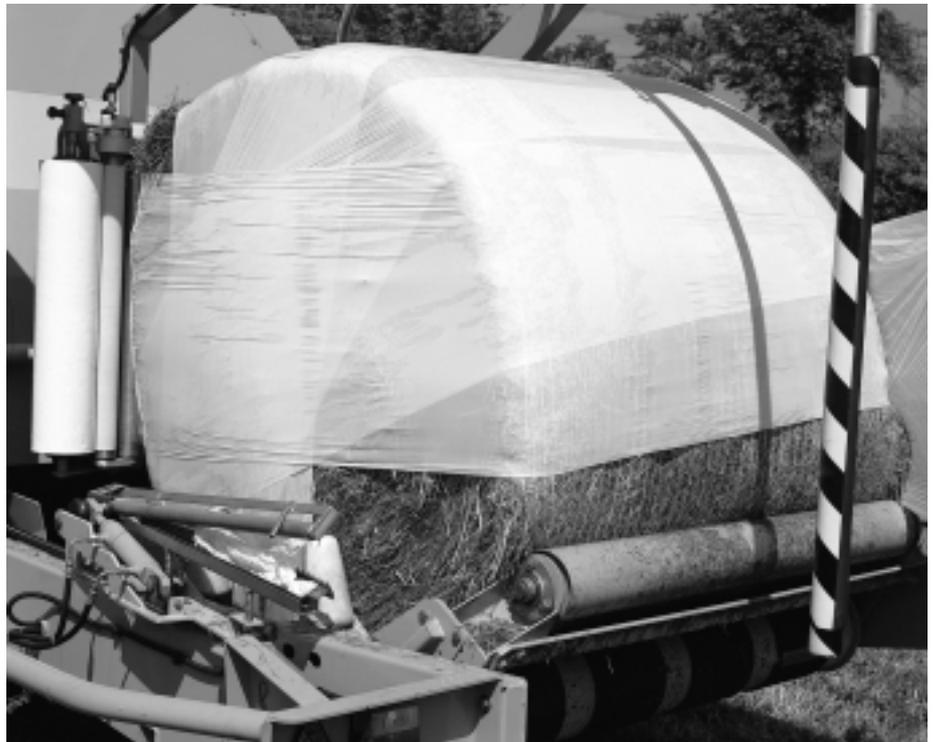
Abb. 7: Der Stretchfolienwickler legt auf die Stirnseite der Ballen mehr Lagen als auf die Bauchseite (Werkfoto: Claas).
