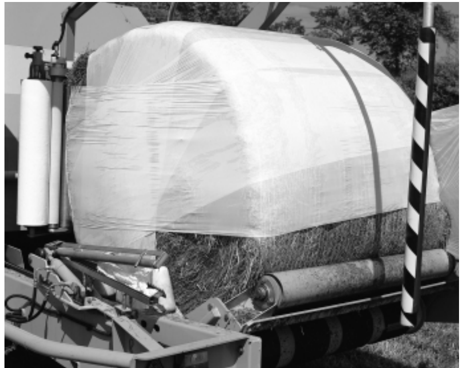
Fig. 7: L'enrubanneuse pose plus de couches de film sur la face plane des balles que sur la face arrondie (photo référencée: Claas)
