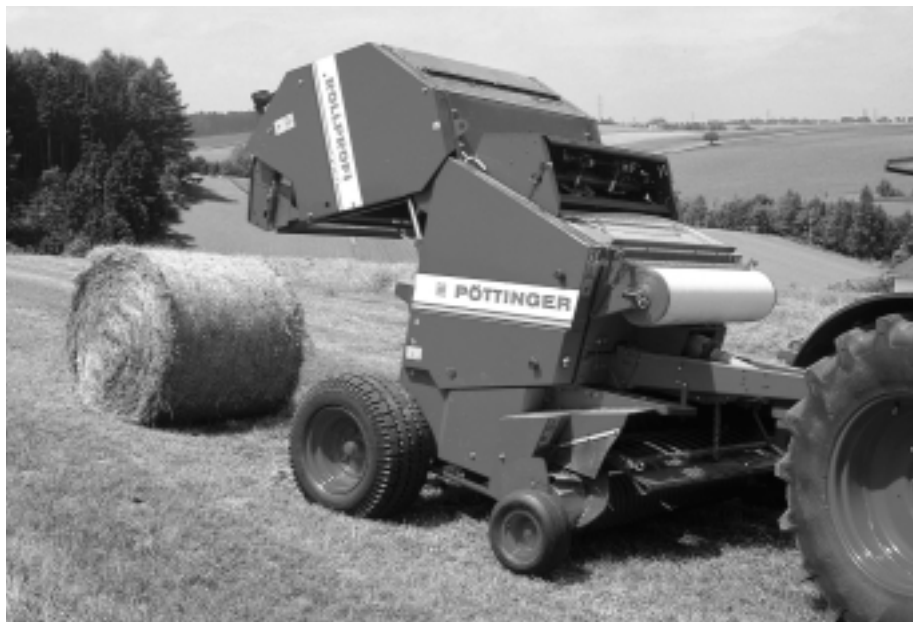
Fig. 2: Presse à balles rondes en action. Le préfanage et une vitesse appropriée lors du pressage permettent d'obtenir des balles d'ensilage de forme régulière (photo référencée: Pöttinger).
