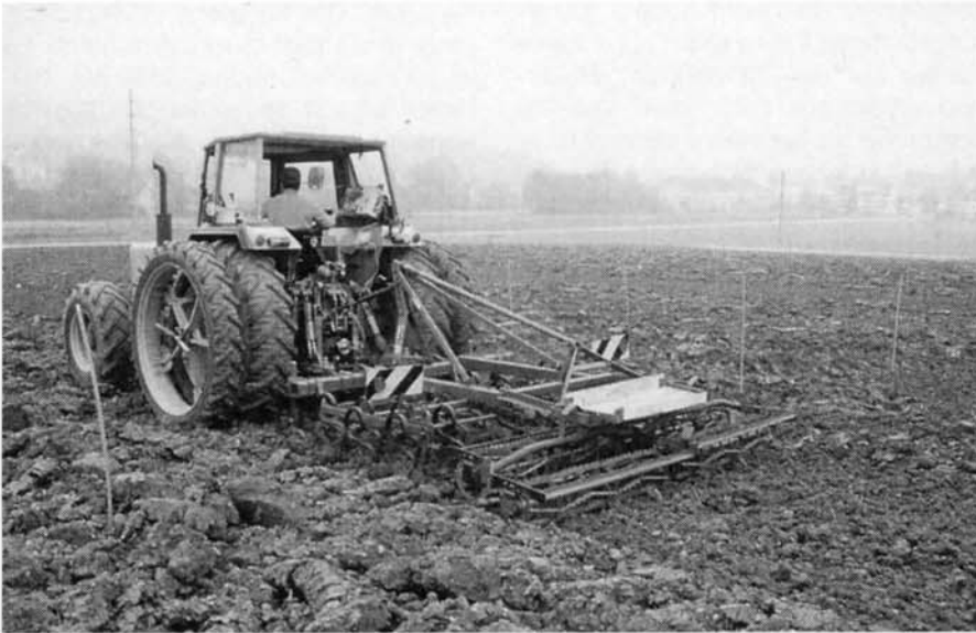
Abb. 4. Die Federzinkenegge benötigt einen sehr kleinen Energiebedarf, ist sehr kostengünstig und erzeugte auf den mittelschweren Böden grobe Saatbetten, die bei Winterweizen aber nie Mindererträge zur Folge hatten.
