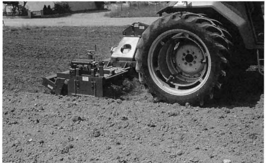
Abb. 3. Die Kreiselegge ebnet die Felder gut ein, arbeitet am feinsten und benötigt bei höheren Fahrgeschwindigkeiten einen erhöhten Zugkraftbedarf.
