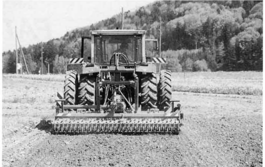
Abb. 2. Der Zinkenrotor besitzt einen guten Einarbeitungseffekt und einen geringen Zugkraftbedarf.
