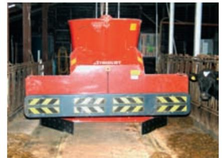
Abb. 8: Der schienengeführte Vertikalmischer (Triomatic) verfügt über zwei Mischschnecken und 3 Kubikmeter Fassungsvermögen. Aufgrund seiner Breite von 1,35 Meter und einer Länge von 3,13 Meter benötigt er eine genügende Futtertischbreite.
