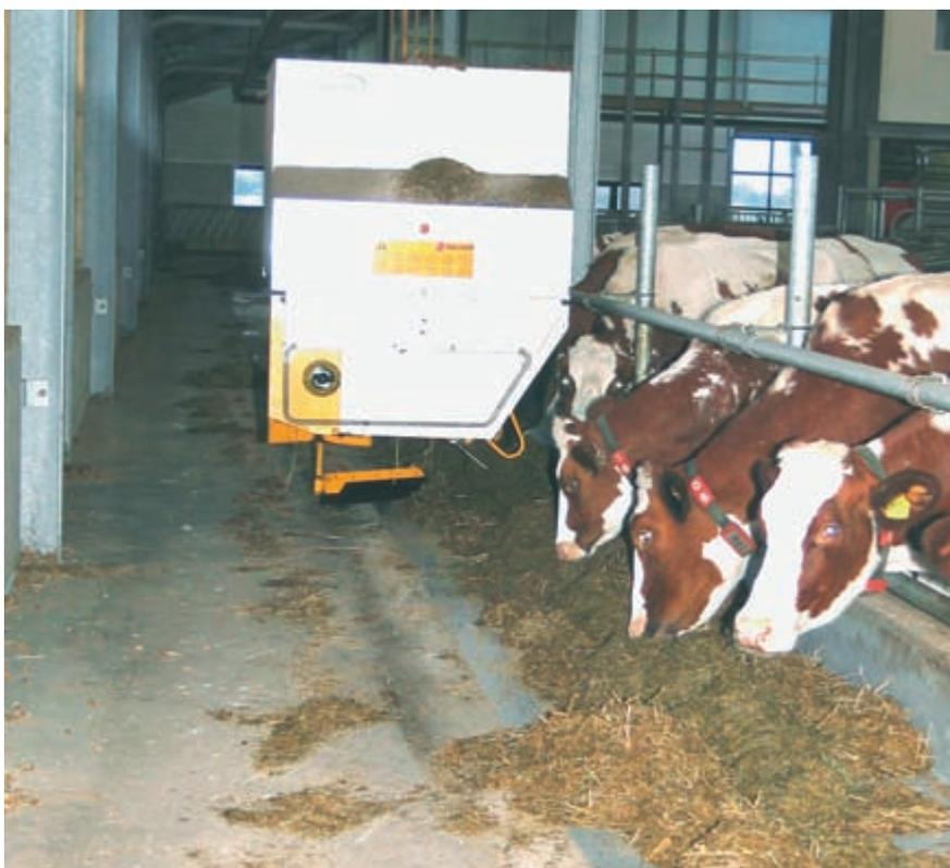
Abb. 1: Automatische Fütterungssysteme versorgen mehrere Tiergruppen rund um die Uhr mit frisch gemischtem Futter.
