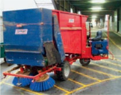
Abb. 4: Der automatische Futterwagen (Cormall) lädt die Ration beim stationären Mischer und fährt anschliessend selbstständig zur Futtervorlage. Der Antrieb erfolgt mit einem Dieselmotor. Mit den Radialbürsten kann er das Futter jederzeit wieder nachschieben.
