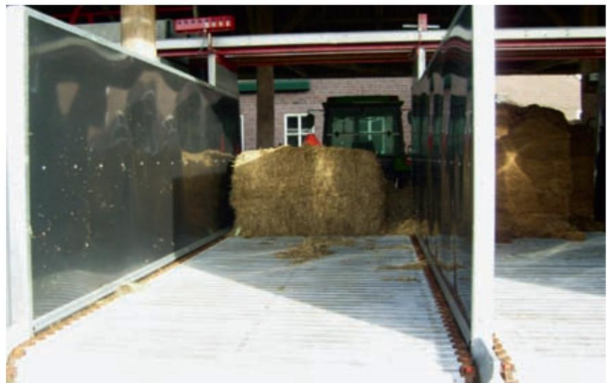
Abb. 11: Das Dosiersystem von Triomatic besteht aus einem Schneidrahmen (links) einem Wiege- und Förderband und mehreren Vorrats- und Zuführtischen für die Futterkomponenten (rechts). Der Schneidrahmen kann Siloblöcke und Grossballen verarbeiten und dabei das Futter auf die gewünschte Länge schneiden.
