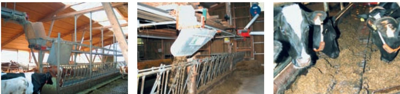
Abb. 3: Futterbänder legen einzelne Futterkomponenten oder Mischungen vor. Sie sind entweder über Kopfhöhe (links und Mitte) oder in der Krippe (rechts) angebracht. Sie sind entweder bei Neuerung direkt einbau- (links und Mitte) oder nachrüstbar.
