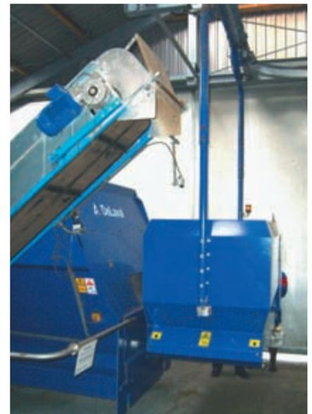
Abb. 9: Ein stationäre Mischer (DeLaval) erstellt die Mischration. Anschliessend beschickt die Beschickanlage den Futterverteilwagen. Sensoren überwachen die korrekte Dosierung.
