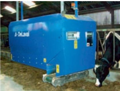
Abb. 5: Der schienengeführte Futterwagen (DeLaval) übernimmt das gemischte Futter vom stationären Mischer. Er kann beidseitig ausdosieren. Der Fütterungsrechner lässt sich ans System Alpro anbinden.
