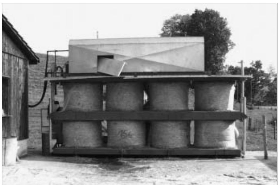
Fig. 3: Système de séchage Inventagri.
