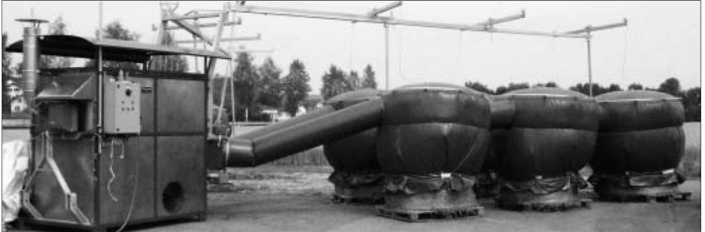
Fig. 6: Système de séchage Tecnolam: ventilation par le haut avec capot et sortie d'air sur la face plane inférieure des balles.
