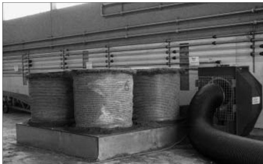
Fig. 4: Système de séchage Geba-Zumstein: ventilation par le bas avec couvercle en bois sur la face plane supérieure et sortie d'air du côté arrondi des balles.
