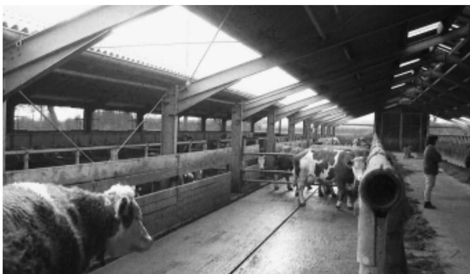
Fig. 12: Étable non isolée D4. L'étable se compose de trois travées en structure métallique avec une ouverture au-dessus de l'aire d'affouragement. Les vaches du côté gauche de l'étable traversent la fourragère pour la traite.
