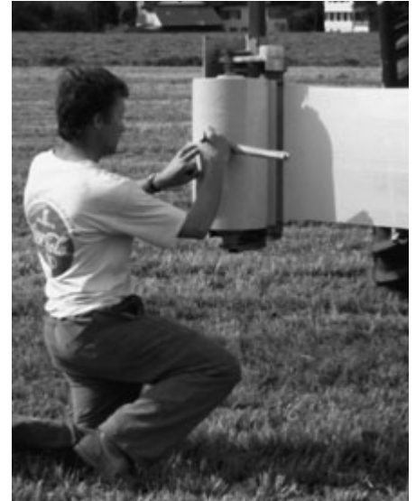
Abb. 17: Beim ersten Einsatz einer neuen Stretchfolie ist am Wickler die richtige Folienvordehnung, Foli­enüberlappung und die gewünschte Lagenzahl zu kontrollieren.
