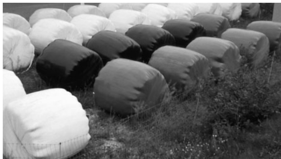
Abb. 1: Fünfzehn verschiedene Wickelfolien wurden in einem Versuch hinsichtlich Qualität, Alterung, Folienerwärmung, Silagequalität und Landschaftsverträglichkeit untersucht.
