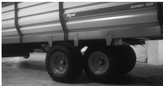
Fig. 2: L'essieu oscillant double (photo de gauche) est la solution la plus avantageuse pour les exploitations herbagères qui récoltent l'herbe chaque jour, car il ménage le sol et la couche herbeuse. L'essieu double décalé est certes moins idéal, mais d'un prix plus avantageux (image de droite).
