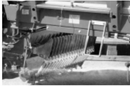
Fig. 10: Les barres de couteaux escamotables à la main ou à l'aide d'un dispositif hydraulique permettent d'éliminer les bourrages au niveau du dispositif de coupe et facilitent l'accès aux couteaux pour les besoins de la maintenance (source: Mengele).
