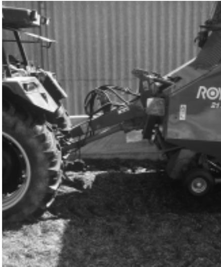
Fig. 12: En cas d'alimentation des silos-couloirs avec la remorque d'ensilage, celle-ci doit être équipée d'un timon hydraulique pour pouvoir circuler sans problème dans les silos-couloirs.
