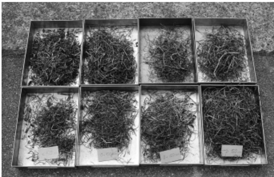
Fig. 17: Sélection des chaumes pour l'analyse de la longueur de coupe des dispositifs installés sur les autochargeuses. Avec le rotor convoyeur (série de cuves supérieure), la qualité de coupe est manifestement meilleure qu'avec le convoyeur oscillant (série de cuves inférieure).
