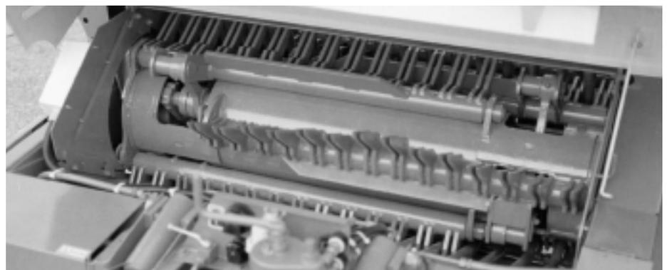
Fig. 7: Le convoyeur oscillant décalé sur le côté est censé réduire le nombre de pointes par rapport aux convoyeurs continus et permettre ainsi un chargement plus régulier (source: Krone).
