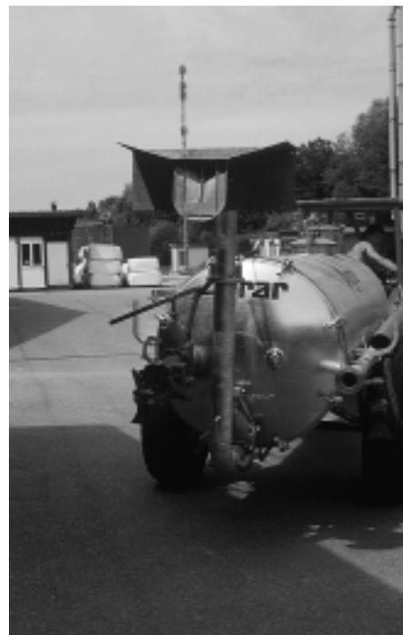
Abb. 3: Hochverteiler sind vor allem für die Anwendung im Ackerbau konzipiert. Ausgerüstet mit einem Teleskoprohr kann die Anbauhöhe des Verteilkopfes verstellt werden.
