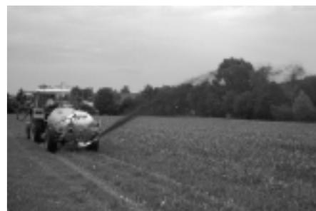
Abb. 11: Seitenverteiler kommen hauptsächlich für das seitliche Bespritzen von Maisäckern oder von nicht befahrbaren Bördern zur Anwendung. Die Verteilgenauigkeit ist ungenügend.
