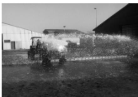
Abb. 10: Tropfengrösse bei Breitverteilern (links zu feinsprühig; rechts ideale Tropfengrösse): Eine grobtropfige Verteilung reduziert die Seitenwindempfindlichkeit und dürfte auch die Gefahr hoher Ammoniakverluste günstig beeinflussen.
