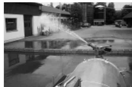
Abb. 14: Bei den Schwenkdüsen ist die Bedienung wegen der erschwerten Sicht auf den Verteiler nicht ganz einfach. Dies und der recht hohe Anschaffungspreis dürften die Hauptgründe sein, weshalb dieses System an Fässern noch wenig verbreitet ist.
