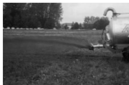
Abb. 6: Schirmprallteller zeichnen sich durch eine sehr bodennahe Ausbringung aus.
