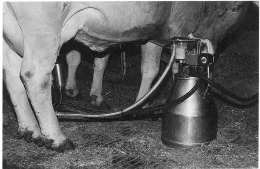
Abb. 3: Duovac 300 auf einer Standeimer-Melkanlage.
