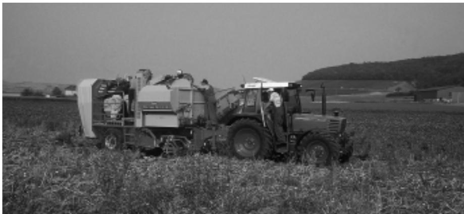
Abb. 6: Der zweireihige Kartoffelvollernter ist sehr leistungsfähig. Er lässt sich jedoch nur bei Erntedämmen mit wenig Steinen und Schollen wirtschaftlich einsetzen.
