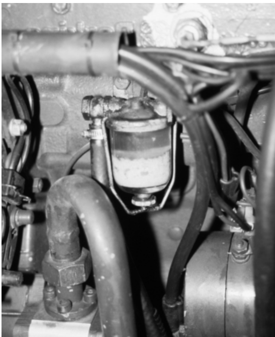
Fig. 10: Regard du filtre de carburant avec amas de billes savonneuses.
