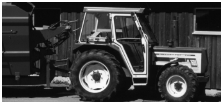
Fig. 1: Tracteur Lindner 1600 A utilisé pour l'essai longue durée avec le mélange à base d'huile de colza et de kérosène.
