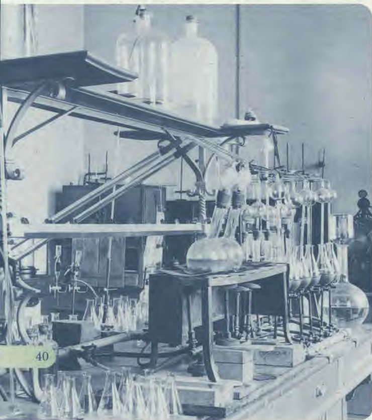
16/ Blick in eines der Labors für Agrikulturchemie, Anlage zur Stickstoff- bestimmung nach Kjeldahl in Oerlikon-Zürich
