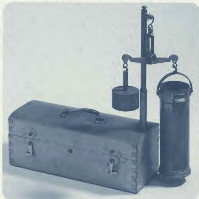
20/ Apparat zur Bestimmung des Hektolitergewichtes von Getreidesamen
