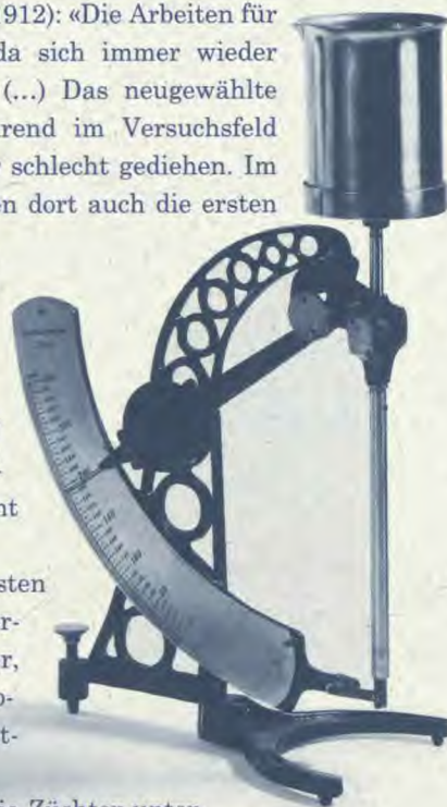
19/ Neigungs- oder Bogenwaage
