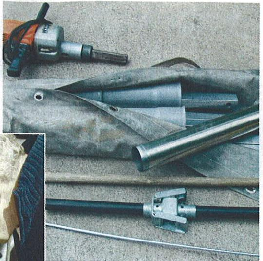
La sonde de gros diamètre est un bon outil pour prendre des échantillons sur le tas de foin.
