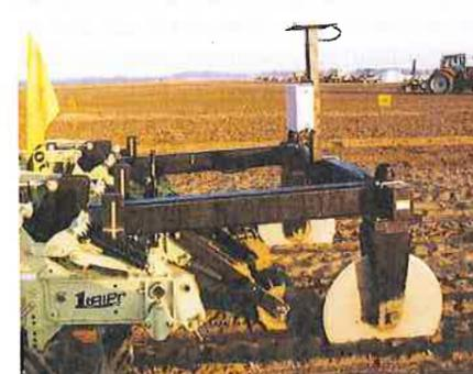
Abb. 4: Nachlaufsteuerungen: Links Trimble TrueTracker, rechts Dammformer mit GPS-gesteuerter Querpositionierung über hydraulischem Verstellrahmen im Dreipunkt.
