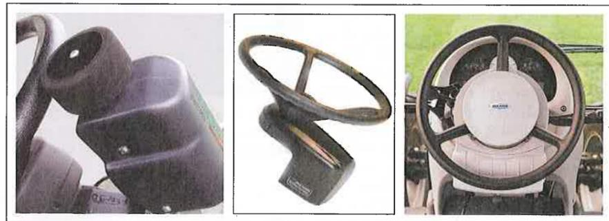
Abb. 8: Möglichkeiten des Lenkeingriffs am Lenkrad: links „Reichhardt RDU“ zur Montage am Lenkrad, Mitte „John-Deere AutoTrac Universal“ als Austausch-Lenkrad, rechts „Autofarm OnTrac2“ zur Montage auf den Speichen des bestehenden Lenkrads.
