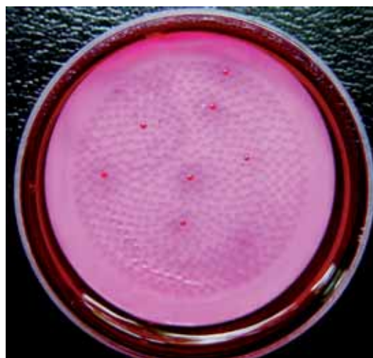
Fig. 4: Détermination quantitative de Clostridium tyrobutyricum avec la méthode de filtration selon Bourgeois & Casey
