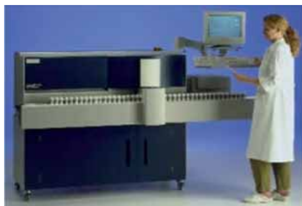
Fig. 1: Dénombrement entièrement automatique de germes dans le lait grâce au Bactoscan (photo: Foss, DK)
