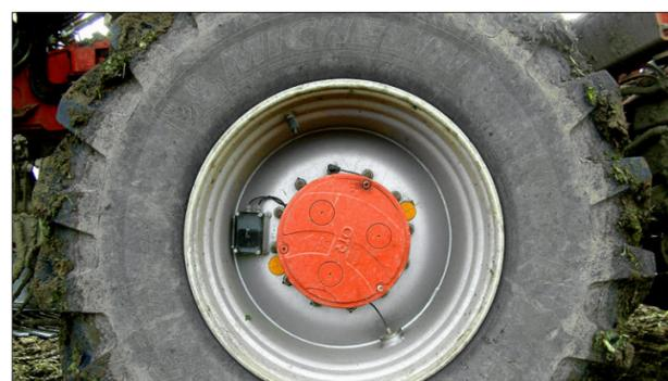
Der Radlastsensor Soil Load Monitor gibt während der Arbeit eine Empfehlung für den richtigen Reifendruck. (Bild: zvg)
