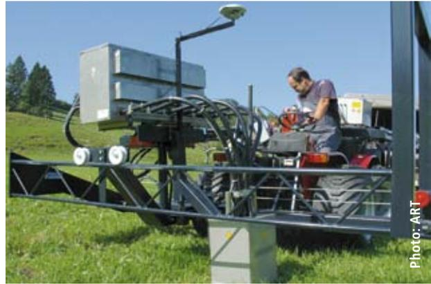
Figure 3 | Appareil prototype I à 4,8 kW de puissance de chauffage.
