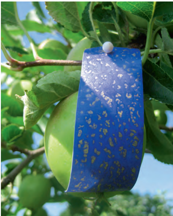
Abb. 5 (rechts): Geringe Tropfenanzahl aufgrund von Abdrift.
