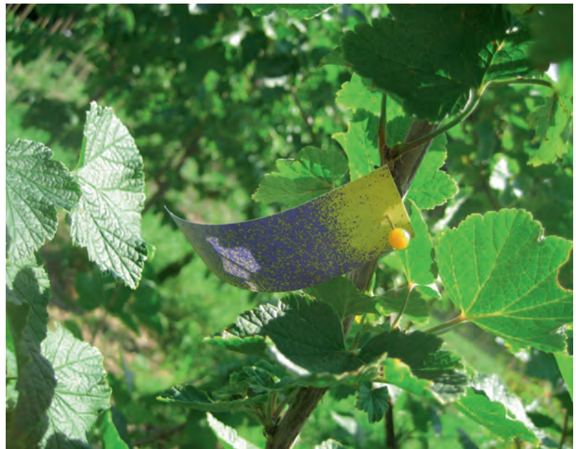
Abb. 6 (links): Hohe Tropfendichte verbunden mit Abtropfverlusten.
