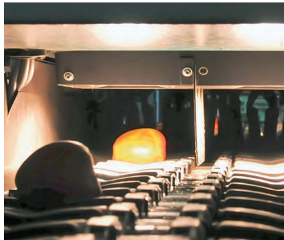
Abb. 3: Zerstörungsfreie Messung von Frucht-eigenschaften mit dem iFA-Modul (Greefa, NL) auf einer Sortieranlage (Tobi Seeobst AG).
