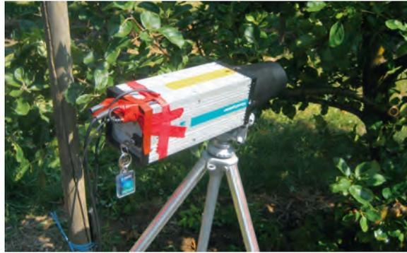
Abb. 1: Positionierung des Anemometers in der Kulturmitte.
