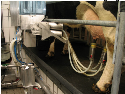
Abb. 1: Viertelindividuelles Melken mit dem MultiLactor®
