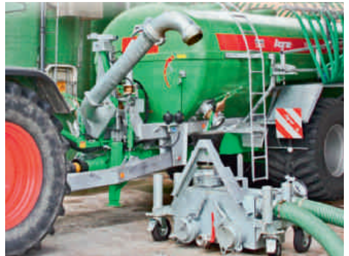
Fig. 11: Les séparateurs mobiles pour remplissage de citerne peuvent également retenir les corps étrangers flottants (photo: GVS, Schaffhausen).
