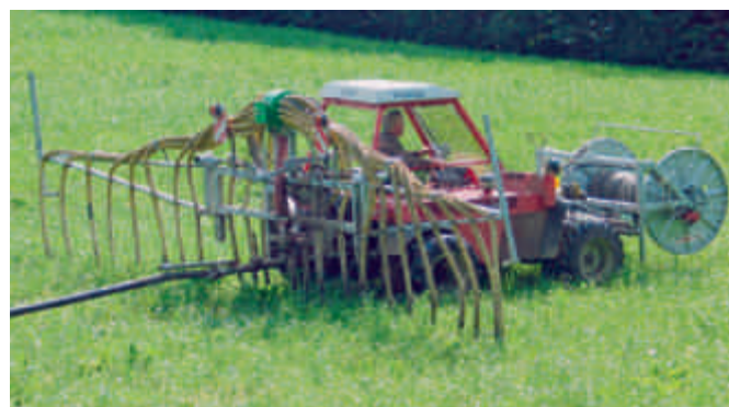
Fig. 1: La tête de distribution ventilée doit toujours se situer au point le plus élevé pour que le lisier puisse s'écouler dans les tuyaux (photo: Joachim Sauter, ART).
