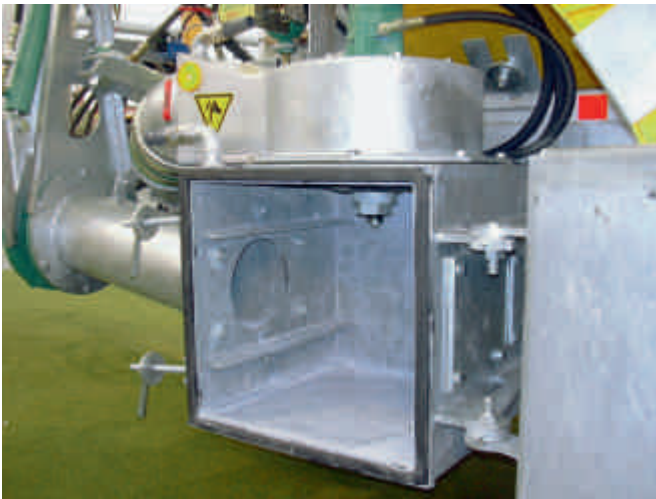
Fig. 10: Les dispositifs de coupe raccordés à la citerne, avec séparateur supplémentaire de corps étrangers réduisent efficacement les bourrages (photo: Joachim Sauter, ART).
