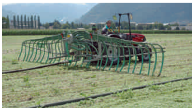
Fig. 2: Sur les systèmes non ventilés, la tête de distribution peut être installée plus bas (photo: Joachim Sauter, ART).
