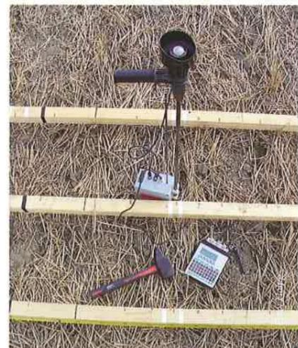
Abb. 5: Rechts: Penetrometer zur Bestimmung des Eindringwiderstandes in den Boden.
