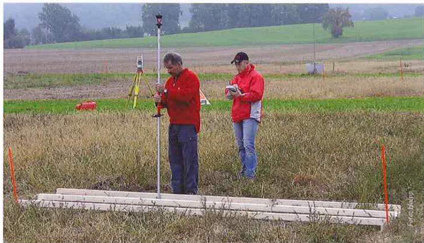
Abb. 5: Links: Vermessung der Bodenoberflächenprofile. Rechts: Penetrometer zur Bestimmung des Eindringwiderstandes in den Boden.
