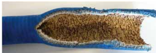
Abbildung 1 : Milchschauch nach einer Nutzungsdauer von 8 Jahren.
