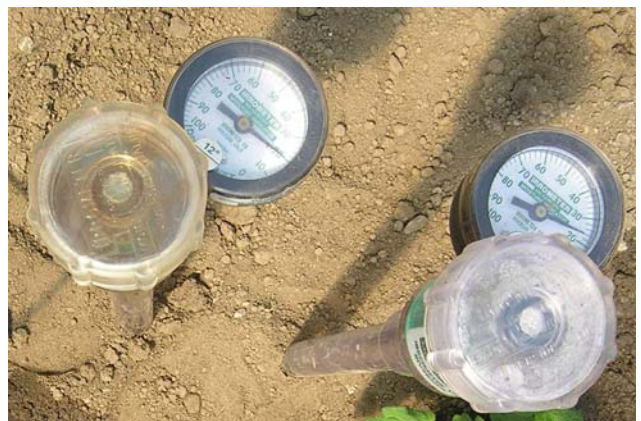
Abb. 6: Tensiometer erlauben es den Zustand der Bodenfeuchtigkeit zu kennen und entsprechend zu bewässern.
