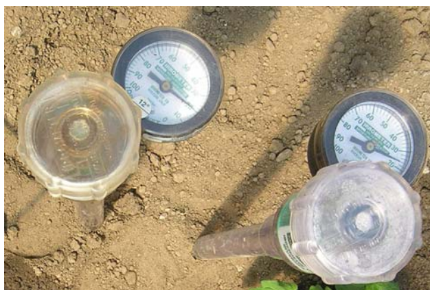
Fig. 6: Les tensiomètres permettent de connaître le degré d'humidité du sol et d'irriguer en conséquence.
