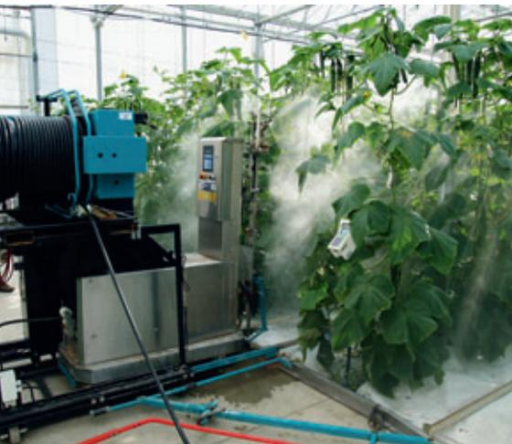
Spritzroboter mit vertikalem Spritzbalken holländischer Bauweise im Einsatz in einem Gurkenbestand in der Westschweiz. Im Vergleich zu einem von einer Person bedienten, konventionellen Spritzbalken montiert auf einem Schienenfahrzeug vermag der Spritzroboter pro Zeiteinheit etwa eine doppelt so große Fläche zu behandeln
