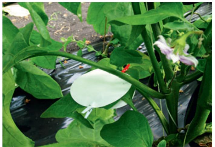
Runde Filterpapierausschnitte (Durchmesser 7 cm) wurden als Kollektoren zur Erfassung der Wirkstoffdeposition auf der Oberseite und Unterseite von Blättern im inneren unteren Bereich und im oberen äußeren Bereich des Pflanzenbestandes an den Positionen A, B, C und D im Gewächshaus angebracht
