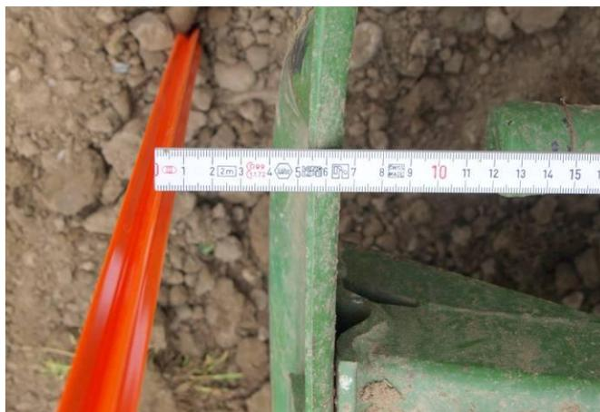
Test der Parallelfahrtgenauigkeit im Feld: Die Fräsmaschine fuhr entlang einer in der Hinfahrt gesetzten 200 Meter langen Basislinie A-B zurück. Am Ausgangspunkt betrug die Abweichung von der Solllinie 5 cm.
