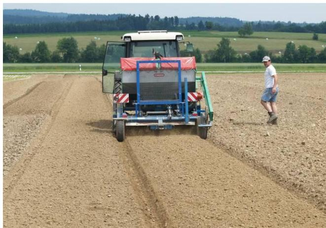
*Einsatz einer Beetfräsmaschine zur präzisen Vorbereitung der Gemüsepflanzbeete. Der Traktor mit GPS-Empfänger erhält hier das nötige Korrektursignal in RTK Präzision von swisstopo über die nächste Antenne des Mobiltelefonfunksystems. Die Beete werden geradlinig und parallel zueinander angelegt mit einer Toleranz von 5 bis 8 cm. Die nachfolgenden Setz- und Hackarbeiten werden dadurch erleichtert und beschleunigt.*
