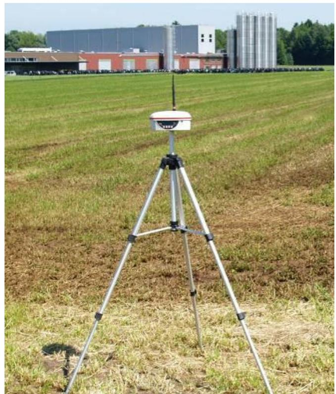
*Die mobile Basisstation (Leica) wird am Feldrand bei freier Rundumsicht aufgestellt. Die Position wird markiert, sodass an nachfolgenden Arbeitstagen die Station wieder genau gleich positioniert werden kann. Das Korrektursignal wird via Funk zum Traktor übertragen, was eine direkte Sichtverbindung erfordert; die Reichweite beträgt dabei ohne Genauigkeitsverlust (bei einer Genauigkeit von  $\pm 5$  cm) maximal 20 km.*
