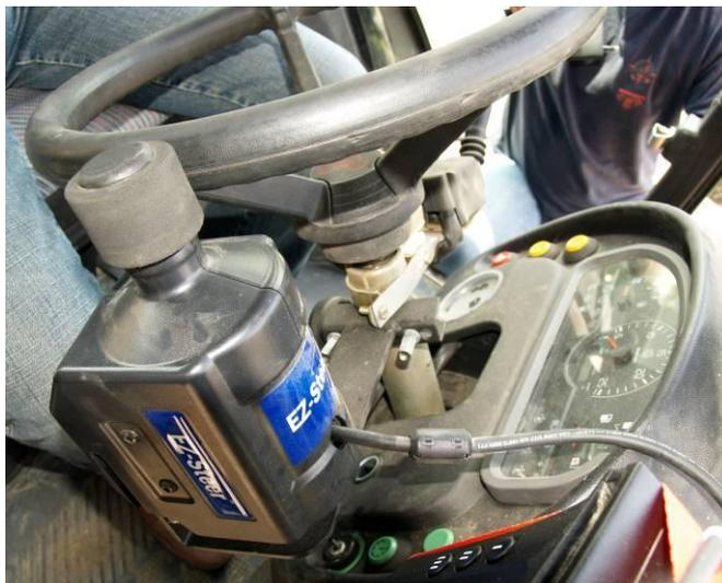
*Die Übertragung des Lenksignals auf die Steuerung des Traktor erfolgt in diesem Falle über einen Elektromotor mit Gummireibrad auf das Lenkrad des Traktors, was jedoch eine langsamere Spurfindung nach sich zieht. Diese Lenksignalübertragung ist etwas langsamer und etwas weniger präzise als ein direkter Eingriff in die Lenkhydraulik, dafür kann das System auch bei älteren Traktoren und abwechslungsweise bei mehreren Traktoren auf dem Betrieb eingesetzt werden.*
