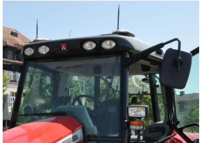
*Die Ausrichtung des Traktors, was linke und rechte Seite in Fahrtrichtung betrifft, ist bereits im Stillstand bekannt dank zwei Antennen auf dem Traktordach. Das Ansteuern der gewünschten Parallelfahrspur am Anhaup des Feldes wird dadurch erleichtert und verkürzt. Bei Verwendung eines Reibradmotors ist allerdings zu beachten, dass mehr Anfahrzeit am Feldrand erforderlich ist (trifft nur für Leica und Autofarm Technologie zu).*
