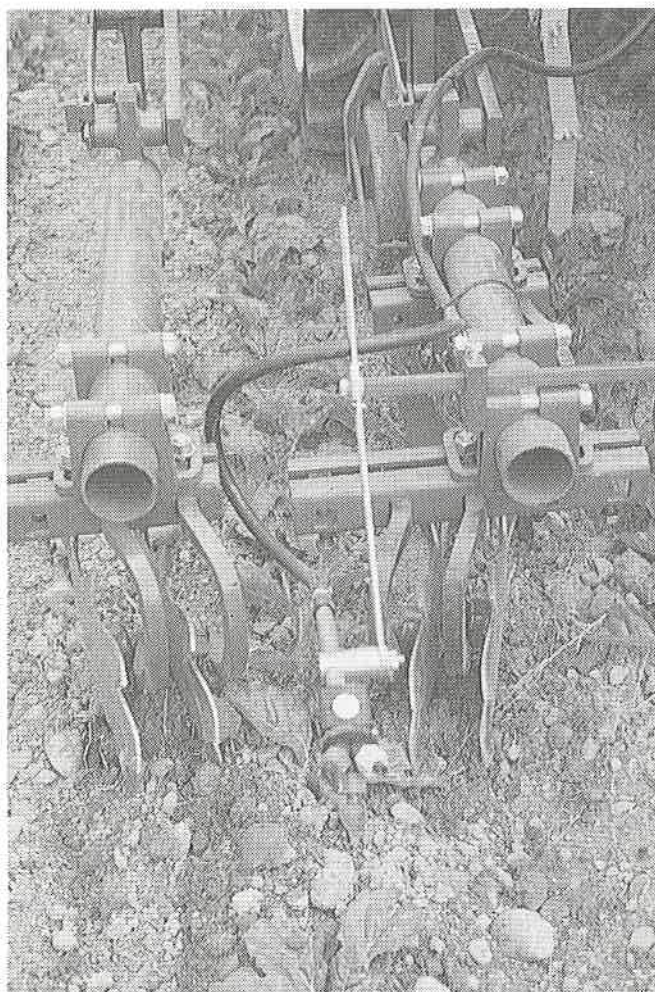
Abb. 3: Das Sternhackgerät mit 25 cm Lockerungsscharen und zwei Zweisternsätzen pro Reihe zeichnet sich durch einen guten Schollenzerkleinerungs-, Wende- und Mulcheffekt aus. Ab 8- bis 10- Blattstadien werden die Rüben leicht angehäufelt.
