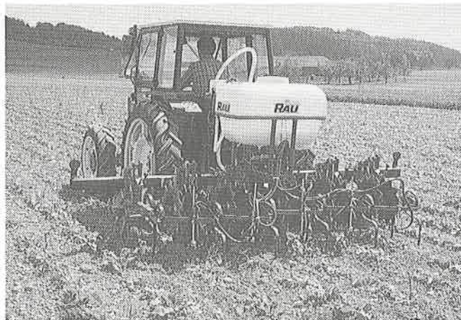
Abb. 2: Mit dem Scharhackgerät I lässt sich in Moor- und steinigen Mineralböden eine gute Arbeitsqualität erreichen. Hackgeräte mit Gänsefußscharen an gefederten Haltern zeichnen sich durch einen besseren Mulch- und Selbstreinigungseffekt aus (rechts: Scharhackgerät II – auch im Mais einsetzbar).
