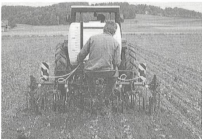
Abb. 2: Mit dem Scharhackgerät I lässt sich in Moor- und steinigen Mineralböden eine gute Arbeitsqualität erreichen. Hackgeräte mit Gänsefußscharen an gefederten Haltern zeichnen sich durch einen besseren Mulch- und Selbstreinigungseffekt aus (rechts: Scharhackgerät II – auch im Mais einsetzbar).
