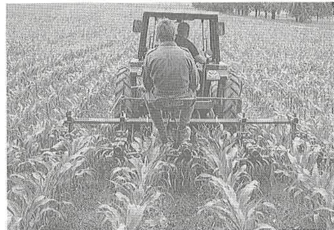
Abb. 10: Das Sternhackgerät mit 28-cm-Lockerungsscharen und spatelförmigen Hacksternen ergab in allen Einsätzen eine gute Arbeitsqualität. Beim zweitem Hacken wurden die Unkräuter in den Reihen durch Anhäufeln bekämpft.
