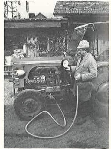
Abb. 4: Kontrolle des Gerätes «Kirpy» beim praktischen Einsatz am Auspuff des Traktors.
