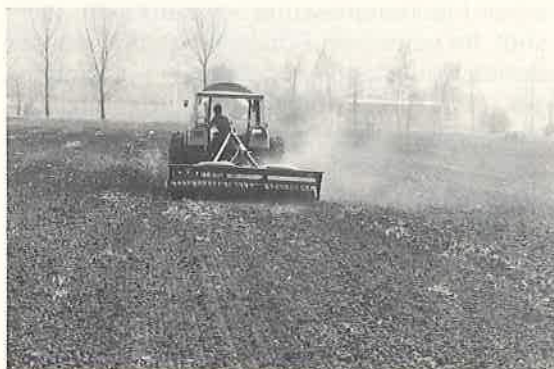
Abb. 3: Der kombinierte Walzeinsatz mit einem Feingrubber bei der Saatbettvorbereitung für Zuckerrüben im Moorboden erfolgte unter optimalen Bedingungen. Mit der langen gekröpften Deichsel der Cambridgewalze (links) konnten praktisch alle Fabrikate (rechts: Ringelwalze) auch an einer Gareegge angehängt werden.
