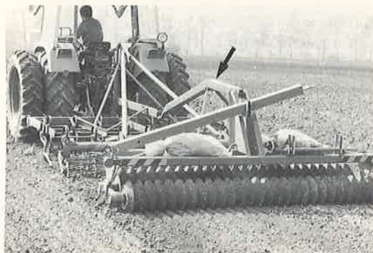
Abb. 3: Der kombinierte Walzeinsatz mit einem Feingrubber bei der Saatbettvorbereitung für Zuckerrüben im Moorboden erfolgte unter optimalen Bedingungen. Mit der langen gekröpften Deichsel der Cambridgewalze (links) konnten praktisch alle Fabrikate (rechts: Ringelwalze) auch an einer Gareegge angehängt werden.
