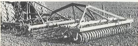
Abb. 7: Saatbettvorbereitung für Raps im Mineralboden. Die Crosskillringe mit geringem Durchmesser sowie die leicht gezahnte Ringelwalze füllten sich gelegentlich mit Erde auf.
