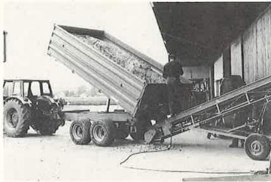
Abb. 9: Der Durchsatz bei den Feuchtgetreidemühlen wird von der Dosierung stark beeinflusst. Dosierung ab Transportwagen genügt in der Regel nicht. Eine regelmässige Beschickung wird mit Förderband oder durch Transportschnecken mit mindestens 15 cm Durchmesser erreicht.
