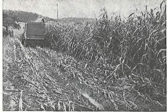
Abb. 1: Ein leistungsfähiger Maishäcksler ist ohne weiteres imstande, im Direktzug einen Traktor von 60 kW (82 PS) an die Leistungsgrenze zu bringen.
