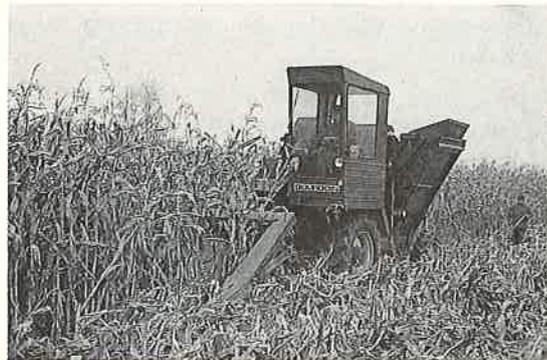
Abb. 2: Selbstfahrender, zweireihiger Kolbenpflücker bei der Arbeit.
