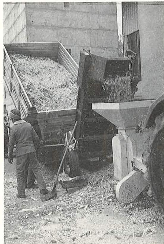
Abb. 4: Korn-Spindelgemisch wird hier stationär geschrotet.
