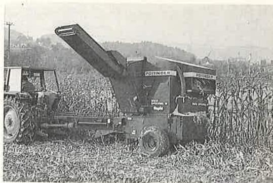
Abb. 5: Zweireihiger Spezialpflückschroter beim prüfungsmässigen Einsatz.
