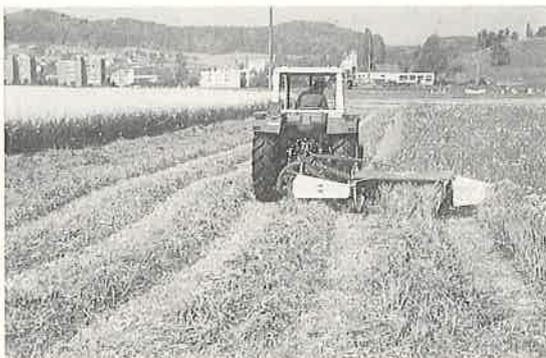
Abb. 6: Wenn bei breiten Traktoren das Futter nicht überfahren werden soll, ist eine Mähbreite von 1,8 m notwendig.
